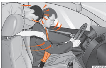
Fig. 9 En bagsædepassager, der ikke har sikkerhedssele på, bliver kastet fremad og ind i den fastspændte fører.
