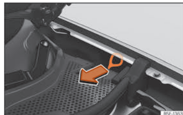
Fig. 230 Mellem venstre skærm og motorhjelmens hængsel: greb til manuel nødoplåsning af ladestikket
