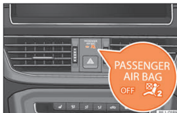
Fig. 18 Instrumentpanel: kontrollampe, der viser, om forsædepassagerens airbag er frakoblet
