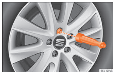
Fig. 39 Hjulsift: Sådan skrues hjulboltene ud med skruetrækkerens greb.
