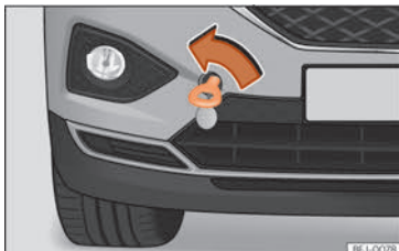
Fig. 46 I højre side af den forreste stødfanger: slæbeøj, der er skruet i
