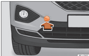
Fig. 45 I højre side af den forreste stødfanger: fjernelse af afdækning
