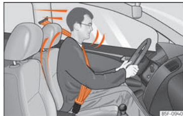
Fig. 7 Hvis sikkerhedsselen er spændt korrekt, bliver føreren ikke kastet frem ved en pludselig opbremsning.
