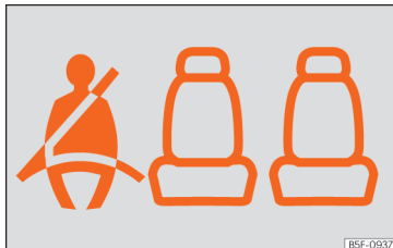
Fig. 6 Kombiinstrument: indikator for, at venstre bagsædeplads er optaget, og at passageren har spændt sin sikkerhedssele
