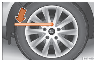
Fig. 35 Hjulskift: løsning af hjulbolte
