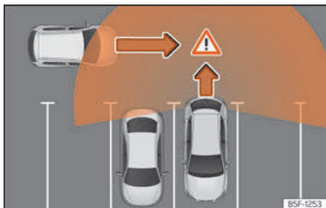
Fig. 198 Skematisk billede af udkørselsassistenten: overvåget område for bil, der kører ud fra parkeringsbås
