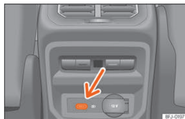
Fig. 160 Midterkonsol bag: USB-porte med stikdåbsfunktion
