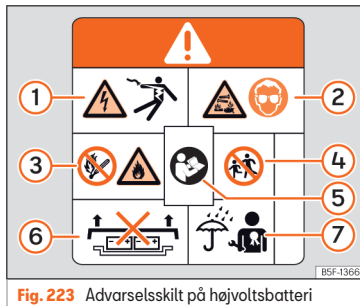
Fig. 223 Advarselsskilt på højvoltsbatteri
