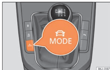
Billede 91 Ved siden af gearstangen: knappen MODE
