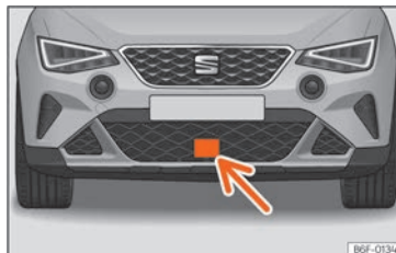
Billede 94 I forreste stødfanger: radarsensor
