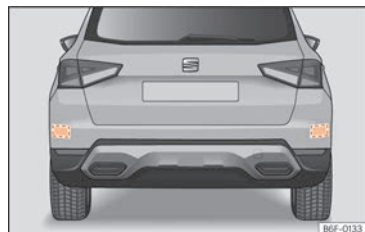
Billede 97 Område bag bilen: områder for radarsensorerne
