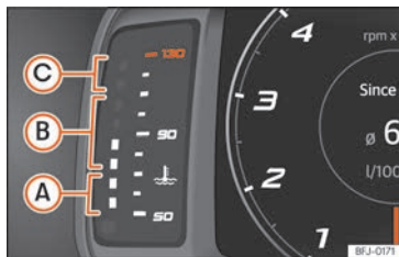
Billede 8 Digitalt kombiinstrument SEAT Digital Cockpit: motorkølevæsketermometer
