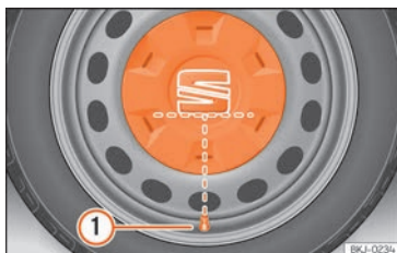
Billede 194 Korrekt placering af hjulkapsel til stålfælg
