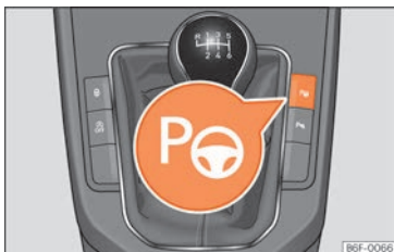
Billede 125 I midterkonsollen: knap til aktivering af parkeringsstyreassistent
