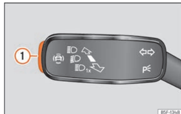
Billede 92 På blink- og fjernlysarmen: knap til førerassistentsystemer (afhængigt af model)
