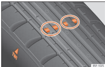
Billede 191 Dækprofil: slidindikatorer
