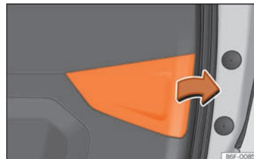
Billede 174 Åben bagklap: Fjernelse af afdækning.
