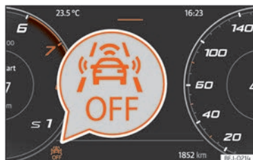
Billede 112 I kombiinstrumentets display: visning af deaktiveret Front Assist
