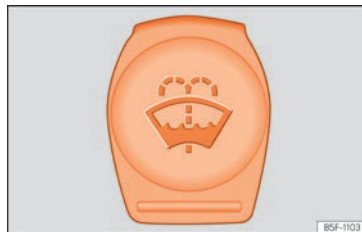
Billede 184 I motorrummet: blåt dæksel på sprinklervæskebeholderen
