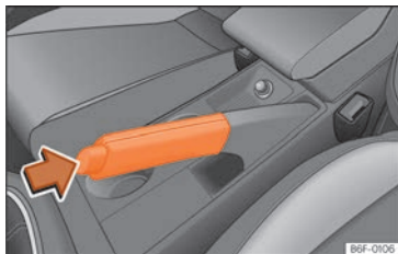
Billede 119 Håndbremse mellem forsæderne.
