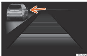
Billede 105 På kombiinstrumentets skærm: ACC aktiv, køretøj registreret i venstre side
