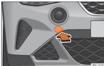
Billede 165 I højre side af den forreste stødfanger: fjernelse af afdækning
