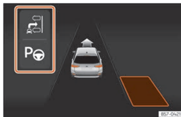
Billede 126 På kombiinstrumentets skærm: visning af parkeringsstyreassistenten med begrænset visning.
