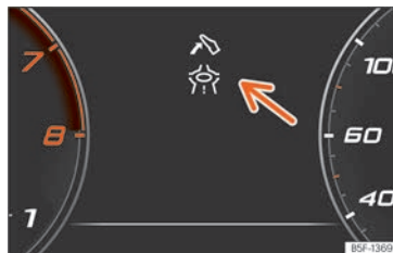
Billede 102 Visning af assistent til miljøvenlig kørestil (skematisk visning)
