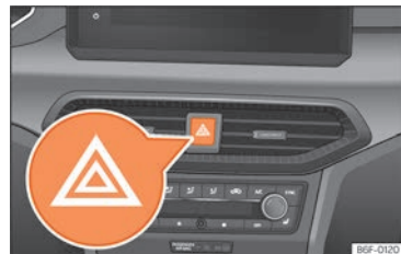
Billede 43 Instrumentpanel: knap til havariblink
