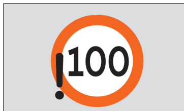
Billede 11 På kombiinstrumentets skærm: overskridelse af den maksimalt tilladte hastighed konstateret (billede)
