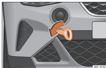
Billede 166 Højre side af den forreste stødfanger: slæbeøjte, der er skruet i
