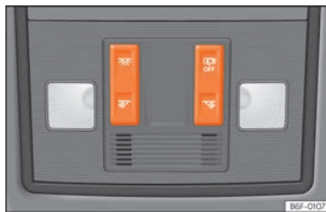
Billede 73 Udsnit af loftet: kabinelys foran
