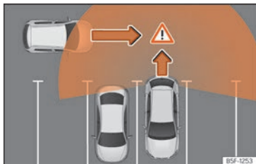
Billede 132 Schematisk billede af udkørselsassistenten: overvåget område for bil, der kører ud fra parkeringsbås
