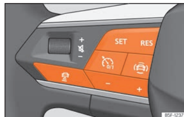
Billede 104 På multifunktionsrattet: knapper til betjening af ACC
