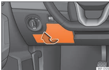
Billede 169 Instrumentpanelet i førersiden: afdækning på sikringsboks
