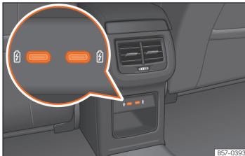
Billede 156 Midterkonsol bag: USB-porte med stikdåsefunktion
