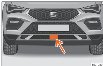
Billede 107 I forreste stødfanger: radarsensor
