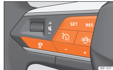
Billede 116 På multifunktionsrattet: knapper til betjening af ACC
