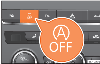
Billede 98 I midterkonsollen: knap til start-stop-system.
