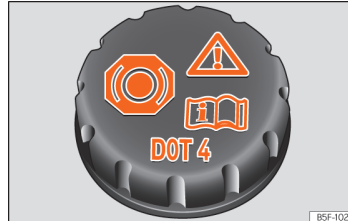
Billede 204 I motorrummet: dæksel på bremsevæskebeholder
