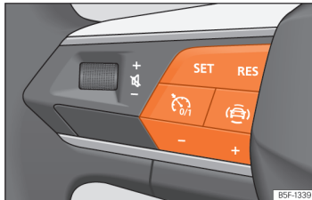
Billede 113 På multifunktionsrattet: knapper til betjening af fartpilot
