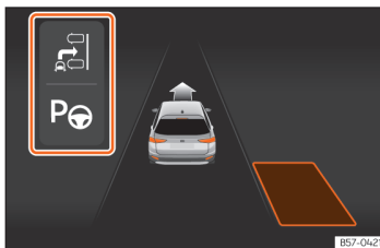
Billede 138 På kombiinstrumentets skærm: visning af parkeringsstyreassistenten med begrænset visning.
