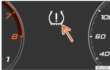
Billede 223 Kombiinstrument: advarsel om tryktab
