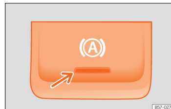
Billede 131 I nederste del af midterkonsollen: funktionsknappen Auto Hold
