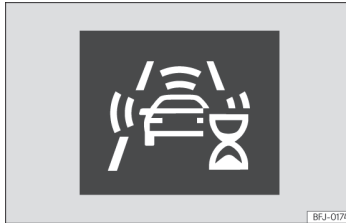
Billede 121 | kombiinstrumentets display: visning af systemets første egenkalibrering
