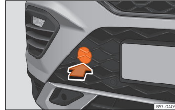
Billede 192 Højre side af den forreste stødfanger: fjernelse af afdækning
