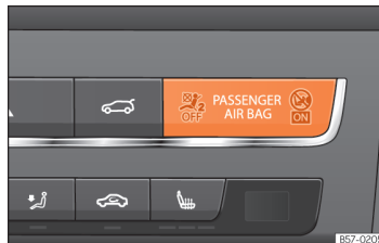
Billede 30 Instrumentpanel: kontrollampe til frakoblet frontairbag til forsædepassager
