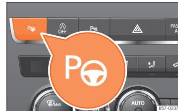
Billede 137 I midterkonsollen øverst: knap til parkeringsstyreassistent
