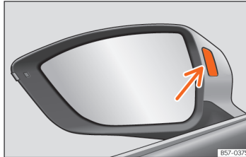
Billede 126 Kontrollampe til vognbaneskiftassistenten
