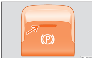
Billede 130 I det nederste område af midterkonsollen: kontakt til elektronisk parkeringsbremse
