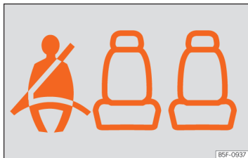
Billede 20 Kombiinstrument: selestatusvisning for bagsædepladserne
