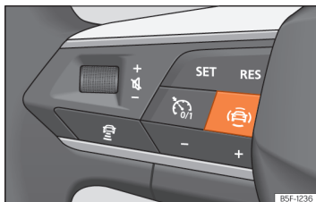
Billede 106 Venstre side af multifunktionsrattet: knap til førerassistentsystemer (afhængigt af model)
