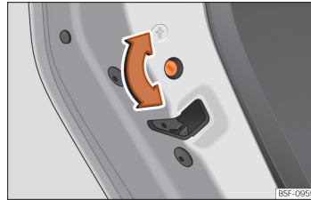
Billede 58 Børnesikring i venstre dør
