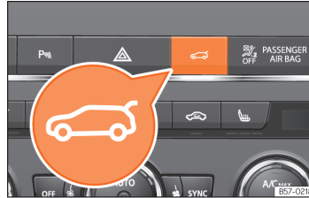
Billede 61 Midterkonsol: knap til åbning og lukning af bagklap.
