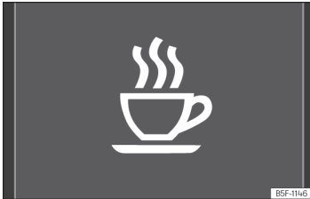
Billede 9 I kombiinstrumentets display: symbol for træthedsregistrering
