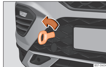
Billede 193 Højre side af den forreste stødfanger: slæbeøjje, der er skruet i
