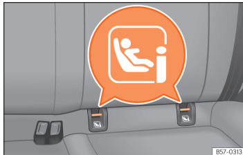
Billede 39 Bagsæde: placering for holdeøjer til ISOFIX eller i-Size
