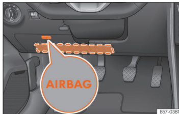
Billede 34 | Førersiden: knæairbaggens monteringssted
