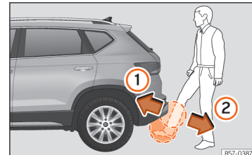
Billede 62 Bagklap med sensorstyret åbning (Easy Open)
