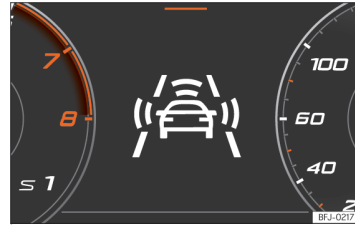
Billede 120 | Kombiinstrumentets display: forvarsel
