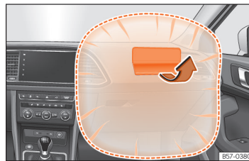
Billede 28 Forsædepassagerens frontairbag i instrumentpanelet
