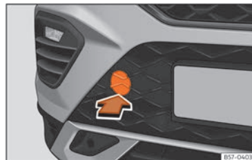
Billede 197 I højre side af den forreste stødfanger: fjernelse af afdækning
