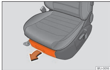
Billede 157 Opbevaringsrum under højre forsæde
