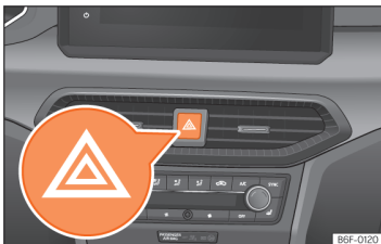
Billede 44 Instrumentpanel: knap til havariblink
