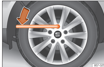
Billede 188 Hjulsift: løsning af hjulbolte
