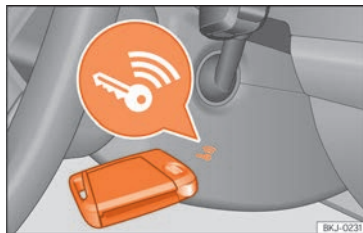
Billede 86 På højre side af ratstamme: nødstart
