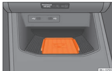
Billede 138 I midterkonsollen: holder til parring af mobiltelefon
