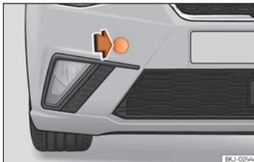
Billede 157 I højre side af den forreste stødfanger: fjernelse af afdækning
