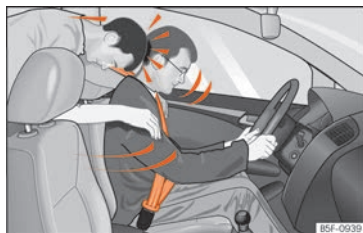
Billede 22 En bagsædepassager, der ikke har sikkerhedssele på, bliver kastet fremad og ind i den fastspændte fører.
