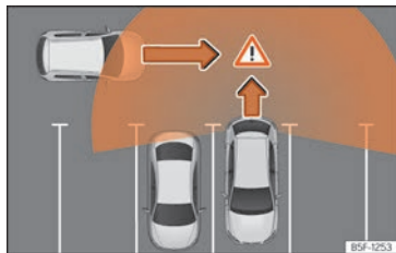
Billede 126 Skematisk billede af udkørselsassistenten: overvåget område for bil, der kører ud fra parkeringsbås
