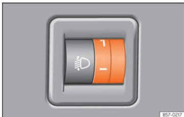
Billede 74 Ved siden af rattet: indstillingshjul til lyslængderegulering
