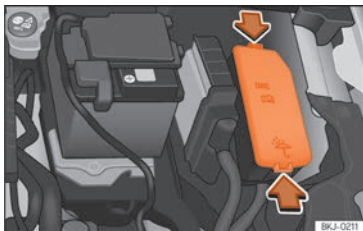
Billede 162 I motorrummet: afdækning på sikringsboks
