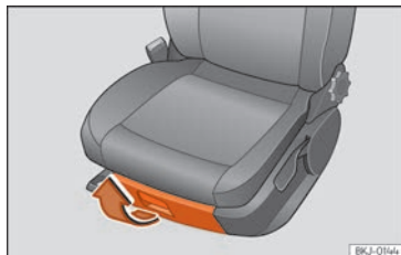
Billede 129 Opbevaringsrum under højre forsæde
