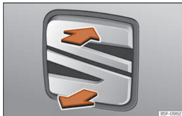
Billede 57 Bagklap: åbning udefra
