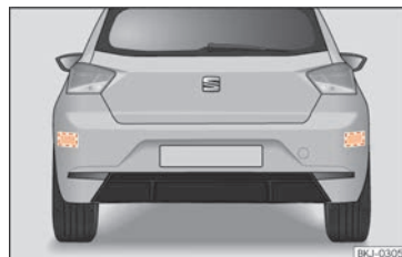
Billede 99 Område bag bilen: områder for radarsensorerne
