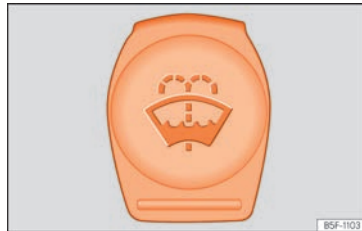
Billede 176 I motorrummet: blåt dæksel på sprinklervæskebeholderen
