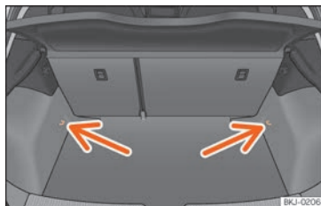
Billede 143 Placering af fastgørelsesøjer i bagagerummet
