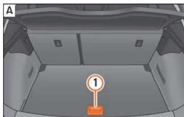
Billede 142 Variabel bagagerumsbund: skrå stilling
