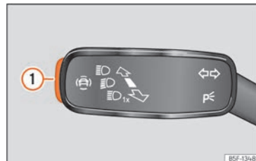
Billede 124 På blink- og fjernlysarmen: knap til førerassistentsystemer (afhængigt af model)
