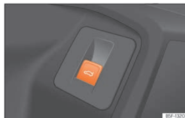
Billede 82 I førerdøren: kontakt til åbning og lukning af bagklap
