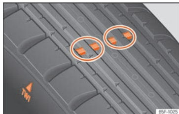
Billede 239 Dækprofil: slidindikatorer
