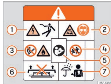
Billede 57 Advarselsskilt på højvoltsbatteri
