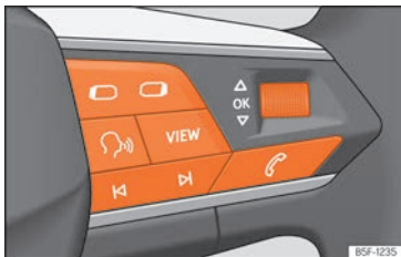
Billede 13 Højre side af multifunktionsrattet: betjeningslementer til menuer og informationer i kombiinstrumentet (afhængigt af model)
