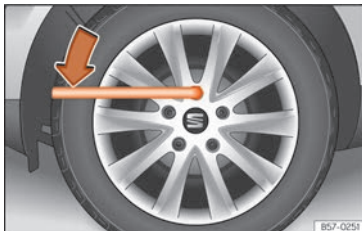
Billede 246 Hjulsift: løsning af hjulbolte
