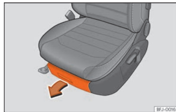
Billede 168 Opbevaringsrum under højre forsæde
