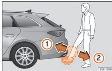
Billede 83 Bagklap med sensorstyret åbning (Easy Open)
