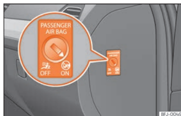
Billede 31 Nøglekontakt til til- og frakobling af forsædepassagerens frontairbag
