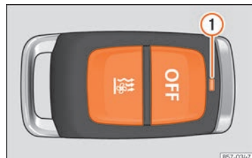
Billede 117 Parkeringsvarme: med fjernbetjening
