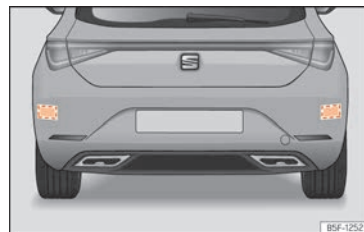
Billede 129 Område bag bilen: områder for radarsensorerne
