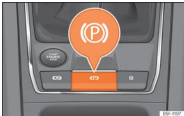
Billede 153 I det nederste område af midterkonsollen: kontakt til elektronisk parkeringsbremse
