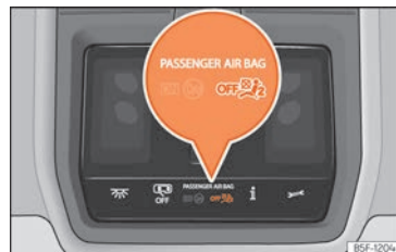
Billede 32 I tagkonsollen: kontrollampe til frakoblet airbag i passagerside
