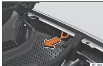
Billede 64 Mellem venstre skærm og frontklappens hængsel: greb til manuel nødoplåsning af ladestikket
