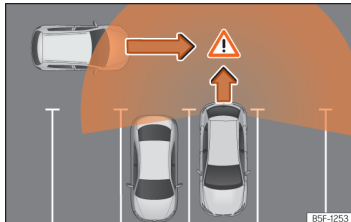
Billede 129 Schematisk billede af udkørselsassistenten: overvåget område for bil, der kører ud fra parkeringsbås
