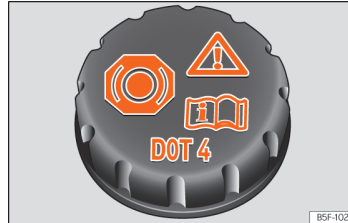
Billede 181 | Motorrummet: dæksel på bremsevæskebeholder
