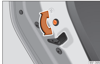
Billede 57 Børnesikring i venstre dør
