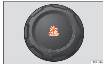
Billede 180 Frontrum: dæksel til kølevæskeekspansionsbeholderen
