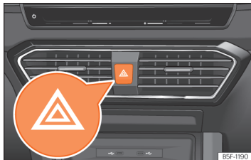
Billede 52 Instrumentpanel: knap til havariblink
