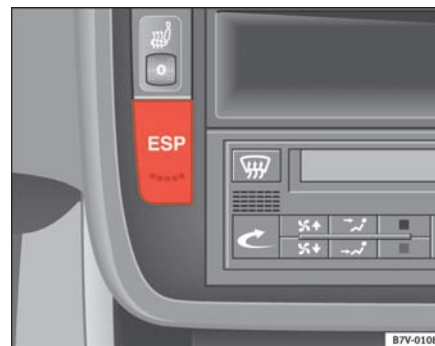
Fig. 125 Udsnit af instrumentpanelet: ESP-knap
