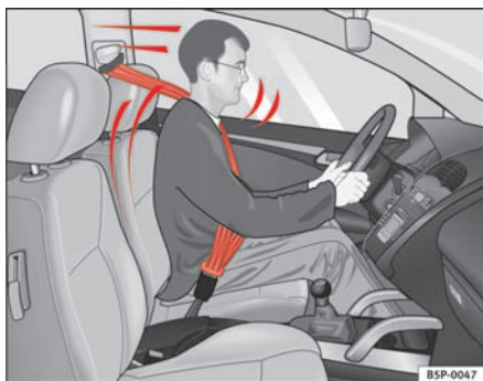
Fig. 9 En fører beskyttet af en korrekt spændt sikkerhedssele under en pludselig opbremsning
