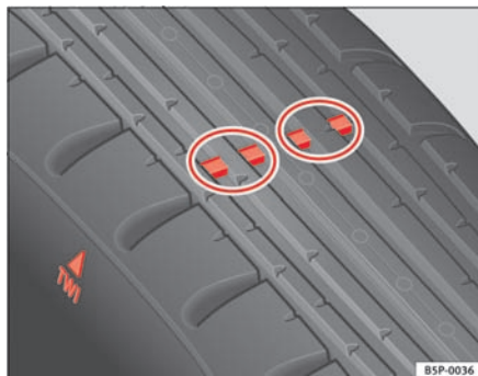
Fig. 150 Slidindikatorer til dækprofil
