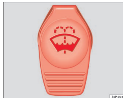
Fig. 145 I motorrummet: dæksel til sprinklervæskebeholder
