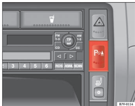
Fig. 132 Udsnit af instrumentpanelet: kontakt til akustisk parkeringshjælp
