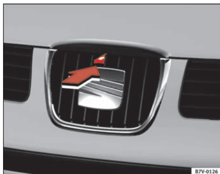
Fig. 140 Udsnit af kølergrillen: Sådan åbnes motorhjelmen.
