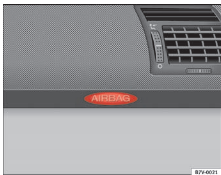
Fig. 23 Forsædepassagerens airbag er placeret i instrumentpanelet.
