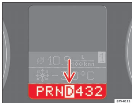
Fig. 129 Udsnit af instrumentpanelet: Displayet viser gearvælgerens position.
