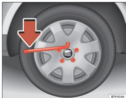
Fig. 158 Hjulskift: Sådan løsnes hjulboltene.
