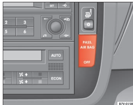
Fig. 29 Advarselslampe til frakobling af airbag i instrumentpanel
