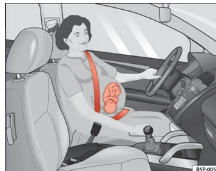
Fig. 14 Selens placering på gravide
