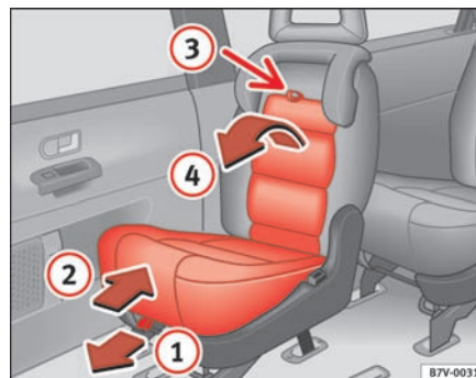
Fig. 35 Betjening af det integrerede børnesæde
