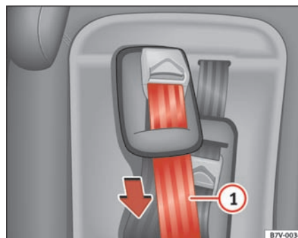
Fig. 38 Udsnit af det integrerede børnesæde: H-sele-indstilling
