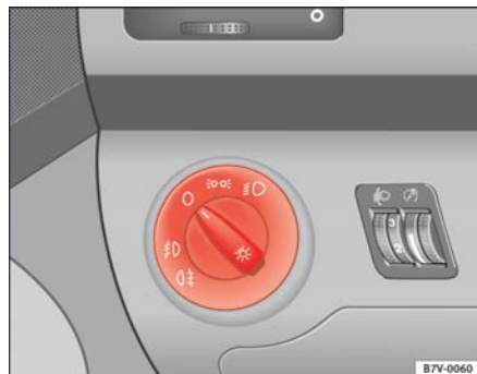
Fig. 71 Udsnit af instrumentpanelet: kontakt til lys, tågeforlygter og tågebaglygte
