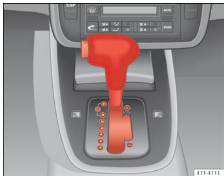
Fig. 130 Udsnit af midterkonsollen: gearvælger med låseknop
