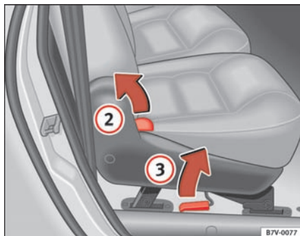
Fig. 91 Sædet set fra siden: Sådan klappes ryglænet og sædet frem.
