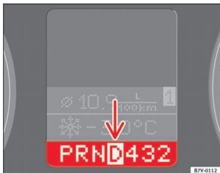
Fig. 131 Udsnit af instrumentpanelet: Displayet viser gearvælgerens position.
