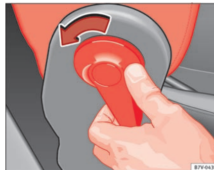
Fig. 83 Sådan frigøres passagersædets ryglæn, der kan klappes frem og tilbage.
