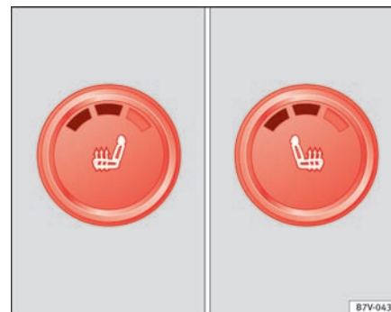
Fig. 79 Billede af midterkonsollen: knapper til sædevarme i forsæderne – her ved indstillet andet varmetrin
