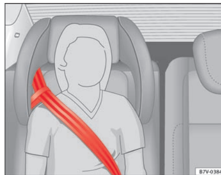
Fig. 32 Integreret børnesæde: Sådan placeres sikkerhedsselen med seleføringsstrop.
