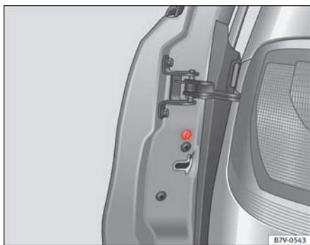
Fig. 186 For enden af passagerdøren: nødlås – gemt bag en gummitætning
