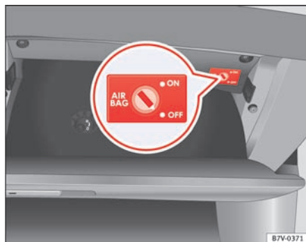
Fig. 19 I handskerummet: nøglekontakt til fra- og tilkobling af forsædepassagerens frontairbag
