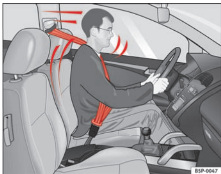
Fig. 9 En fører, der har sikkerhedssæle på, bliver holdt fast af den korrekt spændte sikkerhedssæle ved en pludselig opbremsning.
