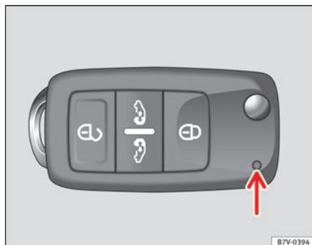
Fig. 42 Kontrollampe i bilnøgler til biler med elektriske skydedøre
