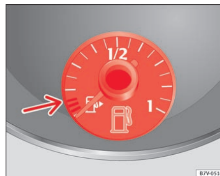
Fig. 159 I kombiinstrumentet: tankmåler til benzin- og dieselbrændstof
