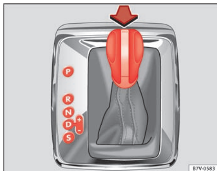
Fig. 130 Venstrestyret bil: gearvælger til automatisk gearkasse med låseknop (pil)
