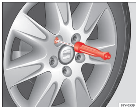
Fig. 182 Hjulsift: Sådan skrues hjulboltene af med skruetrækkerens greb.
