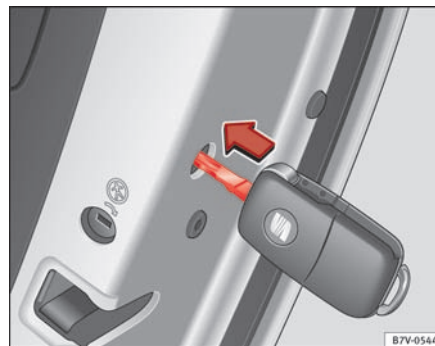
Fig. 187 Nødlåsning af bilen med bilnøglen
