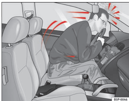
Fig. 7 En fører, der ikke har sikkerhedssele på, bliver kastet fremad.
