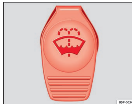
Fig. 71 I motorrummet: dæksel på sprinklervæskebeholderen
