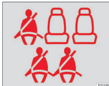
Fig. 4 Eksempel på selestatusvisning for bagsædepladserne (her i forbindelse med syv sæder) i kombiinstrumentet: øverst 2. sæderække, nederst 3. sæderække
