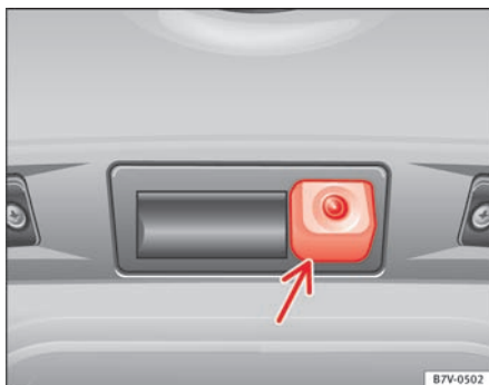
Fig. 145 I bagklappen: placering af kamera til bakassistent
