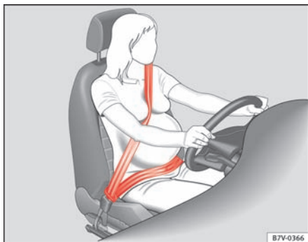
Fig. 14 Korrekt placering af selen på gravide
