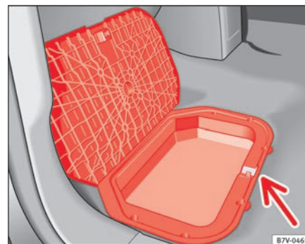
Fig. 109 Opbevaringsrum i fodrummet ved 2. sæderække
