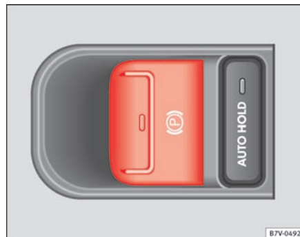
Fig. 134 Billede af midterkonsollen: kontakt til elektronisk parkeringsbremse
