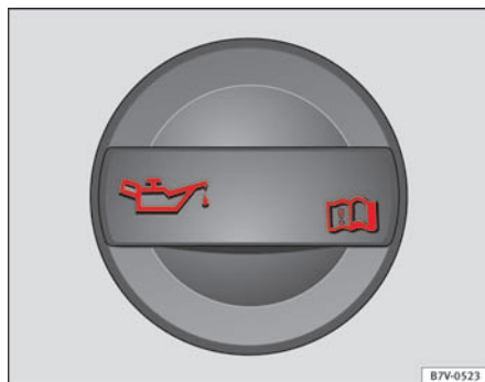
Fig. 166 I motorrummet: dæksel på påfyldningsåbning til motorolie
