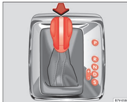
Fig. 131 Højrestyret bil: gearvælger til automatisk gearkasse med låseknop (pil)
