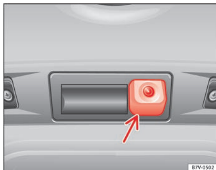
Fig. 145 I bagklappen: placering af kamera til bakassistent
