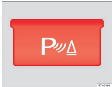
Fig. 139 Billede af midterkonsollen: knap til aktivering og deaktivering af parkeringshjælpen
