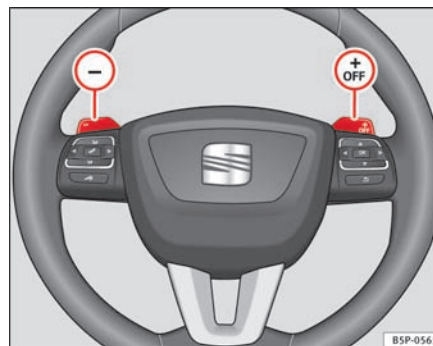
Fig. 133 Rat med to skiftekontakter til tiptronic
