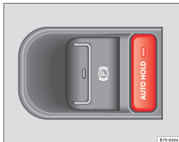
Fig. 139 Billede af midterkonsollen: knap til Auto Hold
