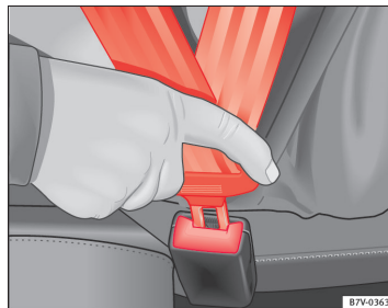
Fig. 10 Sådan sættes sikkerhedsselens låsetap ind i selelåsen.
