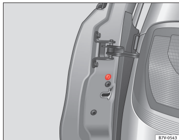
Fig. 191 For enden af passagerdøren: nødlås – gemt bag en gummitætningsliste
