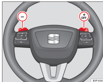
Fig. 135 Rat med to skiftekontakter til tiptronic
