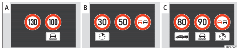
Fig. 154 I kombiinstrumentets display: eksempel på registrerede hastighedsbegrænsninger eller overhalingsforbud med de tilhørende ekstra skilte
