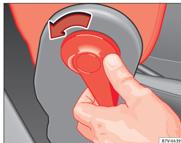
Fig. 83 Frigørelse af klapbart passagersædets ryglæn
