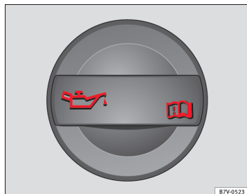
Fig. 171 I motorrummet: dæksel på påfyldningsåbning til motorolie
