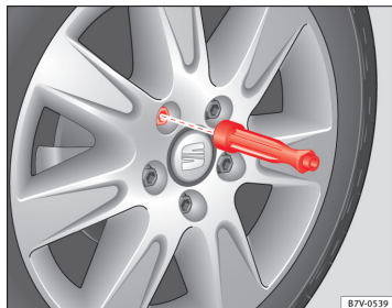
Fig. 187 Hjulsift: Sådan skrues hjulboltene af med skruetrækkerens greb.
