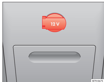
Fig. 120 I midterkonsollen bag: 12-volts-stikdåse
