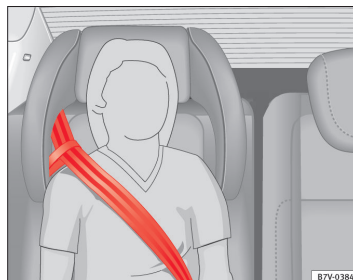
Fig. 32 Integreret børnesæde: Sådan placeres sikkerhedsselen med seleføringsstrop.
