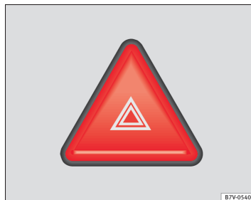
Fig. 188 Midten af instrumentpanelet: knap til havariblink
