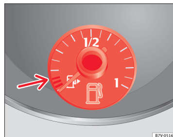
Fig. 164 I kombiinstrumentet: tankmåler til benzin- og dieselbrændstof
