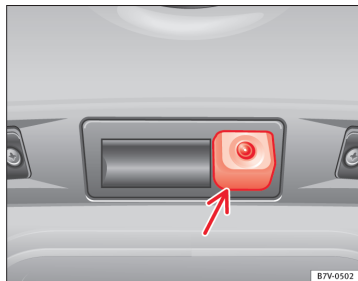
Fig. 147 I bagklappen: placering af kamera til bakassistent
