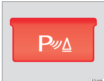
Fig. 141 Billede af midterkonsollen: knap til aktivering og deaktivering af parkeringshjælpen
