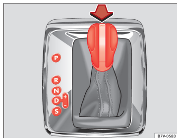
Fig. 132 Venstrestyret bil: gearvælger til automatisk gearkasse med låseknop (pil)
