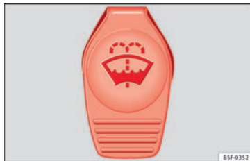
Fig. 246 I motorrummet: dæksel på sprinklervæskebeholder
