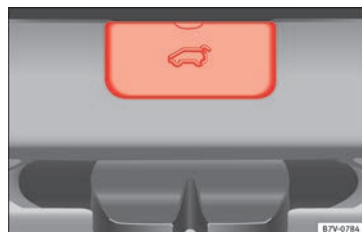
Fig. 8 Fra bagagerummet: afmontering af afdækning til bagklap
