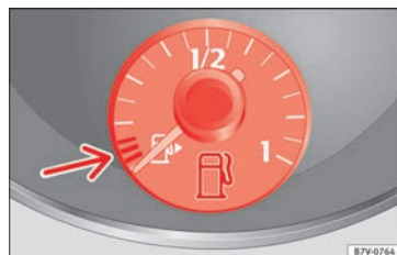
Fig. 233 I kombiinstrumentet: tankmåler til benzin og diesel
