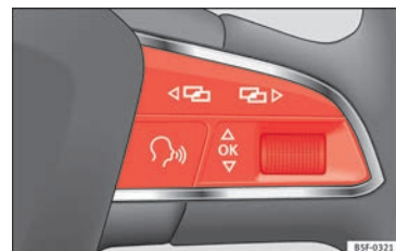
Fig. 46 Multifunktionsrattet: knapper til betjening af menuerne i kombiinstrumentet
