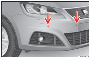
Fig. 209 Parkeringshjælpen sensorer i den forreste stødfanger
