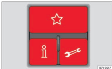
Fig. 123 3-knaps-modul i loftet: betjenings-elementer til telefonstyringssystem
