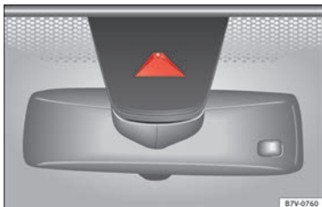
Fig. 219 På forruden: vognbaneassistentens kamerafelt
