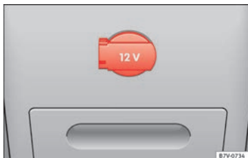
Fig. 193 Bageste side af midterkonsollen: 12-volts-stikdåse
