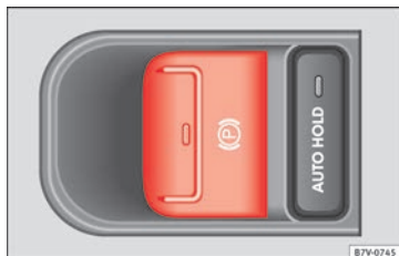
Fig. 201 Detaljer i midterkonsollen: kontakt til elektronisk parkeringsbremse
