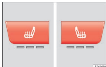
Fig. 155 Udsnit af midterkonsollen: regulator til sædevarme til forsæderne i biler med Climatronic
