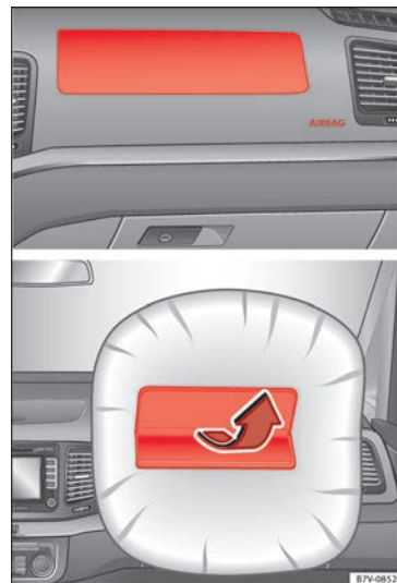
Fig. 27 Placering og virkeområde for forsædepassagerens frontairbag
