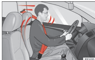
Fig. 85 En fører, der har sikkerhedsselen på, bliver holdt fast af den korrekt spændte sikkerhedsselen ved en pludselig opbremsning.
