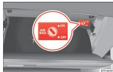
Fig. 28 I handskerummet: nøglekontakt til fra- og tilkobling af forsædepassagerens frontairbag
