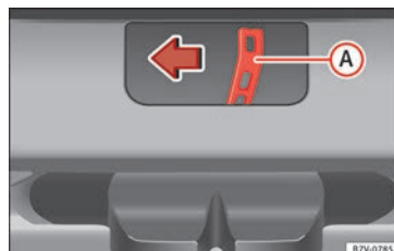
Fig. 9 Fra bagagerummet: nødoplåsning af bagklap
