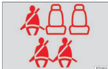
Fig. 84 Eksempel på selestatusvisning for bagsædepladserne (her i forbindelse med syv sæder) i kombiinstrumentet: øverst 2. sæderække, nederst 3. sæderække
