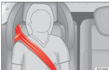
Fig. 97 Integreret børnesæde: placering af sikkerhedssæle med seleføringsstrop
