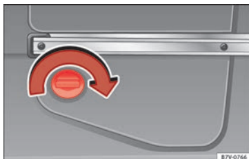
Fig. 235 Bagest i venstre side af bagagerummet: AdBlue-beholder bag en afdækning
