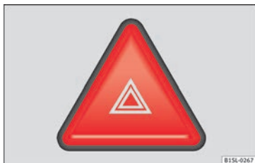
Fig. 140 Udsnit af instrumentpanelet: knap til havariblink
