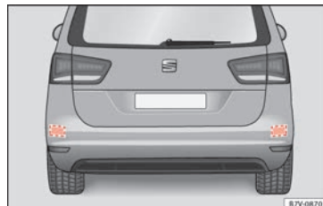
Fig. 221 Område bag bilen: områder for radarsensorerne
