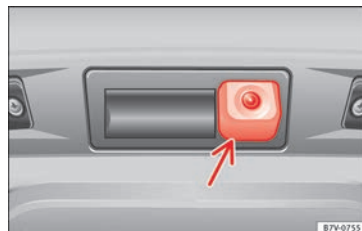
Fig. 214 I bagklappen: placering af kamera til bakassistent
