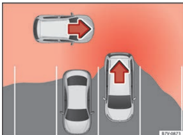
Fig. 224 Skematisk billede af udkørselsassistenten: overvåget område for bil, der kører ud fra parkeringsbås
