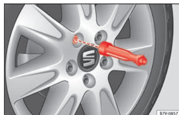
Fig. 72 Hjulskift: Sådan skrues hjulboltene ud med skruetrækkerens greb.
