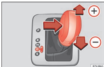
Fig. 203 Gearvælger i tiptronic-position (venstrestyret bil) For højrestyrede biler er det spejlvendt.
