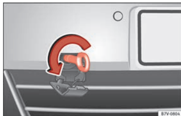
Fig. 73 I stødfangeren foran til højre: Sådan skrues slæbeøj i.
