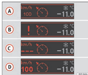
Fig. 218 I kombiinstrumentets display: fartpilots forskellige tilstande
