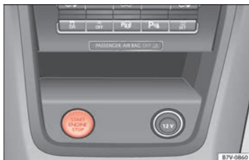
Fig. 199 I midterkonsollen: startknap til det nøglefrie låse- og startsystem Keyless Access. I højrestyrede biler er placeringen symmetrisk.
