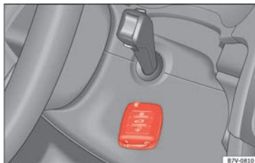
Fig. 200 Nødstart i forbindelse med biler med låse- og startsystemet KESSY
