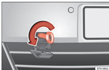
Fig. 104 I stødfangeren foran til højre: Sådan skrues slæbøjlet i.
