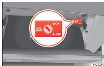
Fig. 93 I handskerummet: nøglekontakt til fra- og tilkobling af forsædepassagerens frontairbag
