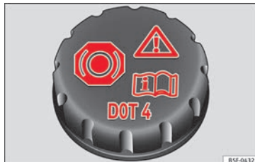
Fig. 245 I motorrummet: dæksel til bremsevæskebeholder
