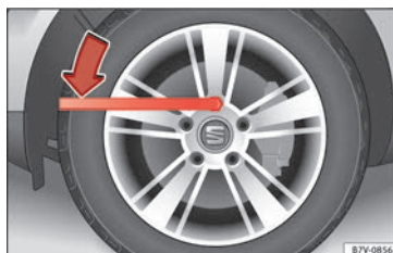
Fig. 68 Hjulskift: Sådan løsnes hjulboltene
