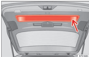
Fig. 137 Åben bagklap: greb til at lukke bagklappen med
