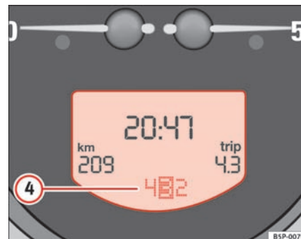
Fig. 37 Instrumentpanelet: display med angivelse af gear (tiptronic)
