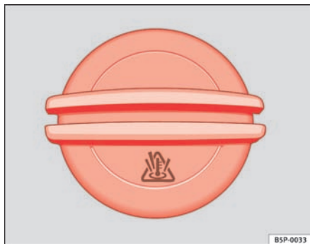
Fig. 160 I motorrummet: dæksel til kølevæskeholderen
