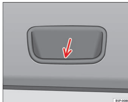
Fig. 67 Udsnit af bagklappens indvendige beklædning: greb til at lukke bagklappen med
