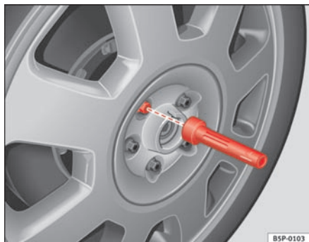
Fig. 173 Hjulskift: indvendig sekskant, som boltene kan skrues ud og i med
