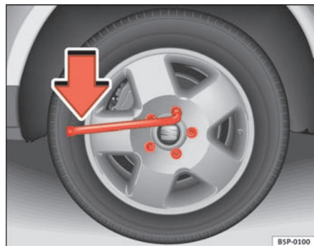
Fig. 170 Hjulskift: Sådan løsnes hjulboltene.
