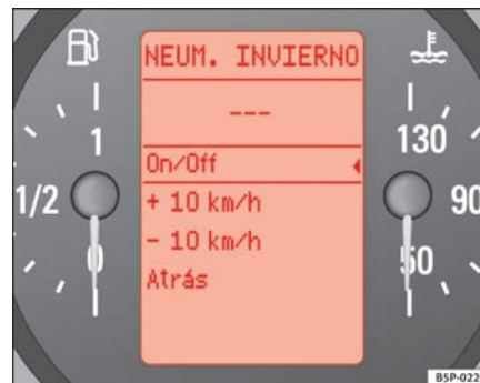
Fig. 46 Digitalt display i instrumentpanelet: indikator for vinterdæk
