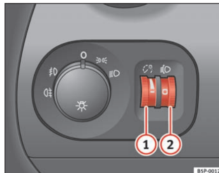
Fig. 75 Instrumentpanel: indstillingshjul til instrument- og kontaktbelysning samt til lyslængderegulering
