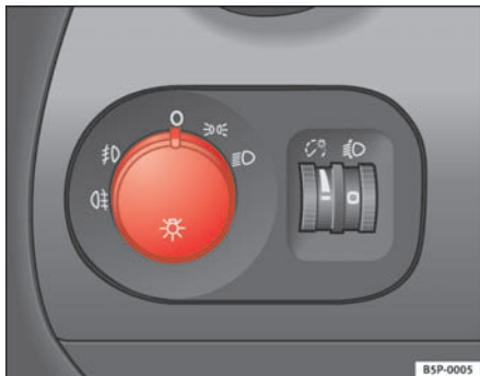
Fig. 73 Udsnit af instrumentpanelet: lyskontakt, tågeforlygter og tågebaglygte
