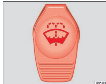
Fig. 161 I motorrummet: dækslet til sprinklervæskebeholder
