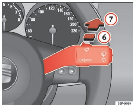
Fig. 87 Betjeningsarm til viskere og sprinklere: bagrudevisker
