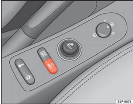
Fig. 48 Midterkonsollen: knap til dækkontrolvisning
