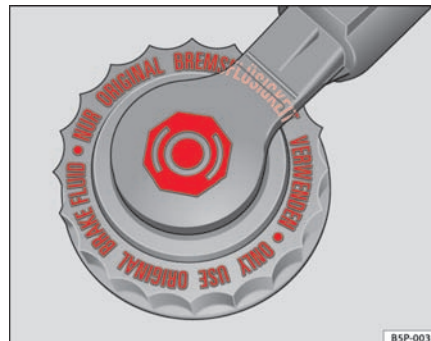
Fig. 165 I motorrummet: afdækning til bremsevæskebeholderen
