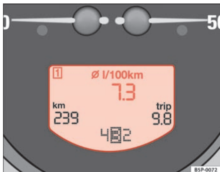
Fig. 42 Digitalt display i instrumentpanelet: visning af gennemsnitligt brændstofforbrug
