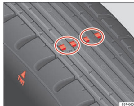
Fig. 166 Slidindikatorer til dækprofil
