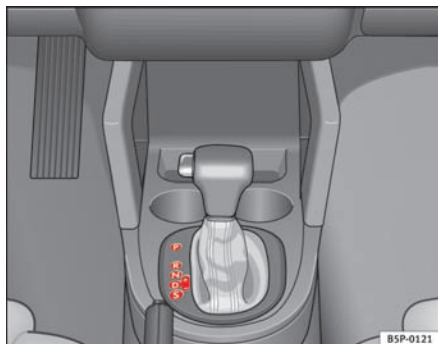
Fig. 133 Midterkonsollen: gearvælger til automatisk gearkasse/direct shift-gearkasse (DSG)
