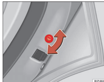
Fig. 62 Børnesikring i højre dør
