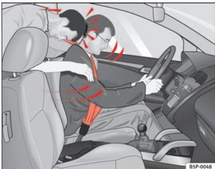
Fig. 10 Bagsædepassageren, som ikke har sikkerhedssele på, kastes voldsomt fremad og rammer føreren, som har sikkerhedssele på.
