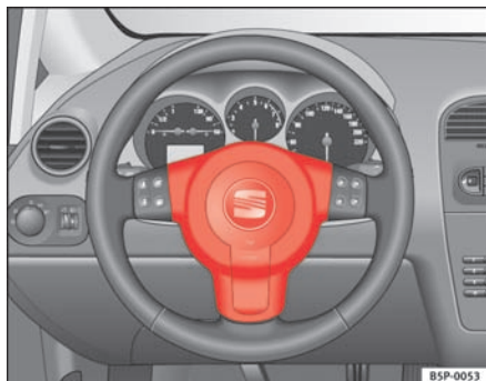
Fig. 18 Førerens airbag er placeret i rattet.
