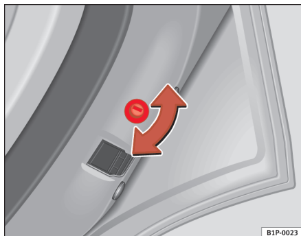
Fig. 62 Børnesikring i højre dør
