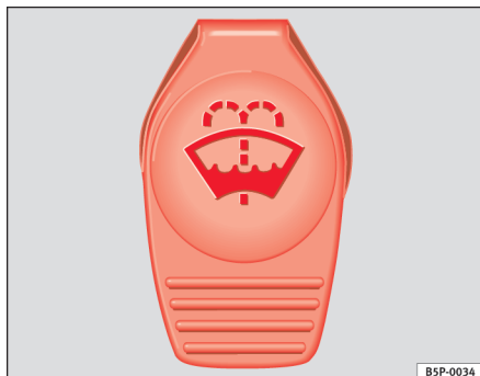
Fig. 167 I motorrummet: dæksel på sprinklervæskebeholderen
