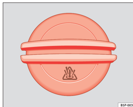
Fig. 166 I motorrummet: kølevæskebeholderens dæksel
