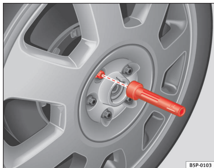
Fig. 180 Hjulskift: indvendige sekskant, som boltene kan skrues ud og i med
