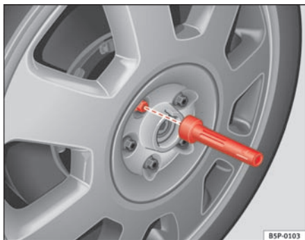
Fig. 175 Hjulskift: Den indvendige sekskant i skruetrækkerens håndtag bruges til at dreje hjulboltene, når de er løsnet.
