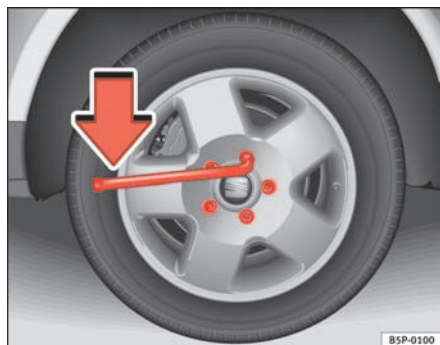
Fig. 172 Hjulskift: Sådan løsnes hjulboltene.
