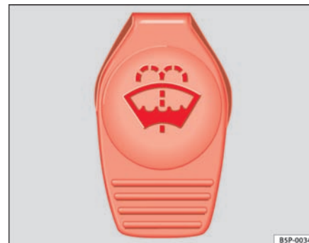
Fig. 163 I motorrummet: dækslet til sprinklervæskebeholder
