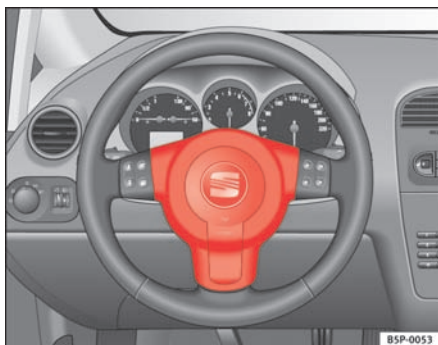
Fig. 18 Førerens airbag er placeret i rattet.
