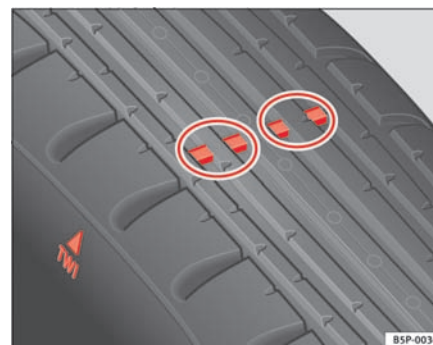
Fig. 168 Slidindikatorer til dækprofil
