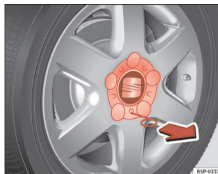
Fig. 171 Hjulskift: Sådan tages centerkapslerne af.
