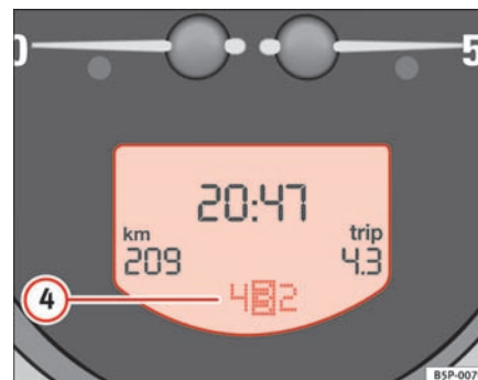
Fig. 37 Udsnit af instrumentpanelet: display med visning af gearvalg for tiptronic
