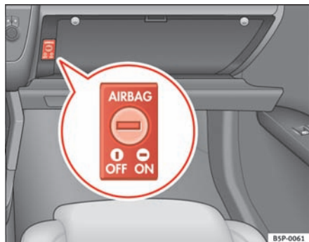
Fig. 26 I handskerummet sidder der en nøglekontakt til fra- og tilkobling af forsædepassagerens airbag.
