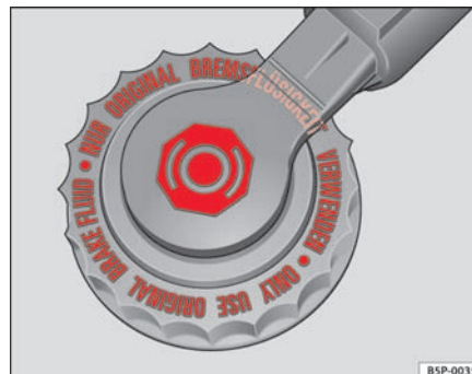
Fig. 172 I motorrummet: afdækning til bremsevæskebeholderen
