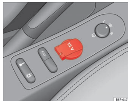
Fig. 118 Stikdåse i midterkonsollen foran
