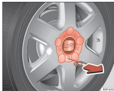
Fig. 176 Hjulskift: Sådan trækkes centerkapslen af.
