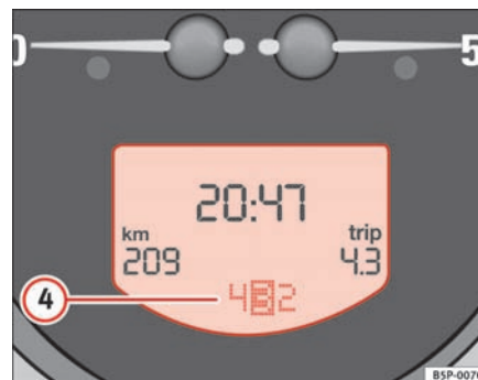
Fig. 37 Udsnit af kombi-instrumentet: display med angivelse af gear (tiptronic)
