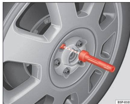
Fig. 181 Hjulskit: indvendig sekskant, som boltene kan skrues ud og i med
