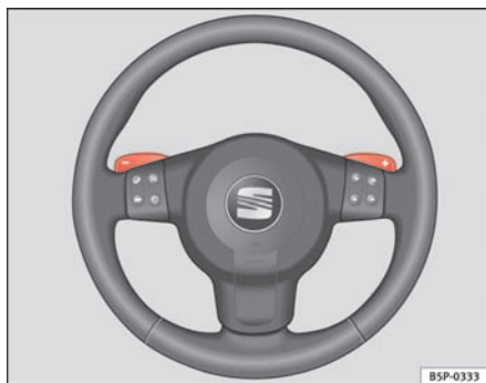
Fig. 145 Rat med skiftekontakter til automatisk gearkasse
