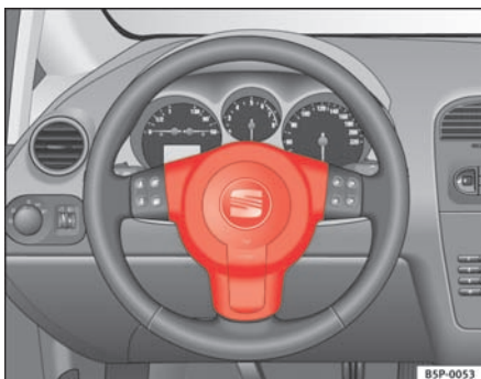
Fig. 18 Førerens airbag er placeret i rattet.
