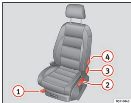
Fig. 95 Betjenings-elementer på venstre forsæde
