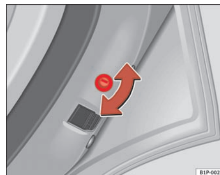
Fig. 62 Børnesikring i højre dør
