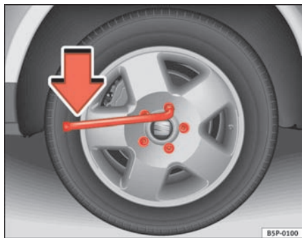
Fig. 177 Hjulskift: Sådan løsnes hjulboltene.
