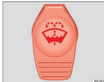
Fig. 168 I motorrummet: dækslet til sprinklervæskebeholder
