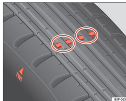
Fig. 173 Slidindikatorer til dækprofil
