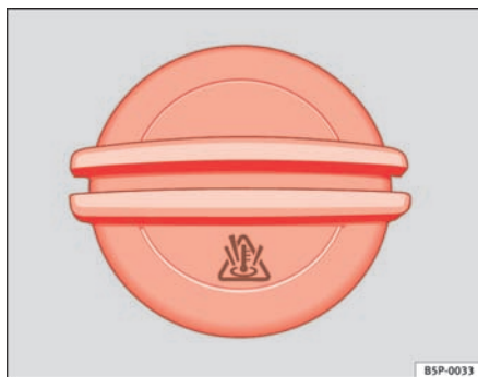
Fig. 167 I motorrummet: dæksel til kølevæskeholderen
