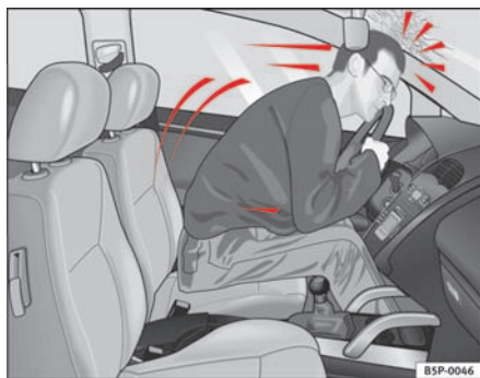
Fig. 9 En fører, som ikke har sikkerhedssele på, kastes voldsomt fremad.
