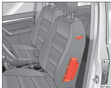
Fig. 22 Sideairbag i førersædet
