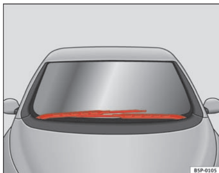
Fig. 169 Forrudevaskere i serviceposition
