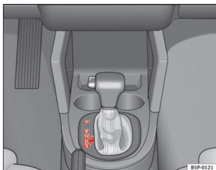
Fig. 140 Midterkonsollen: gearvælger til automatisk gearkasse/direct shift-gearkasse DSG
