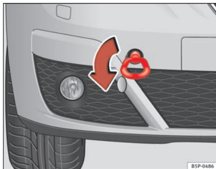
Fig. 207 Foran i højre side: Sådan skrues slæbebøjet i foran.
