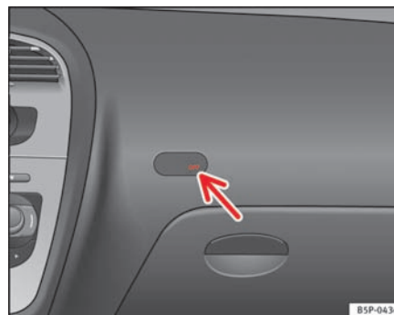
Fig. 27 Kontrollampe, der viser om forsædepassagerens airbag er frakoblet
