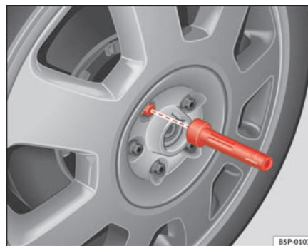
Fig. 183 Hjulskift: indvendig sekskant, som boltene kan skrues ud og i med
