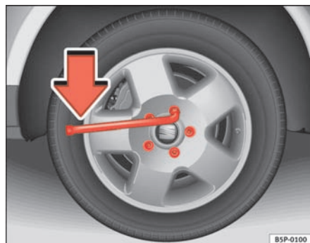
Fig. 179 Hjulskift: Sådan løsnes hjulboltene.
