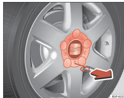
Fig. 178 Hjulskift: Sådan trækkes centercapslen af.
