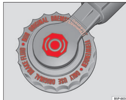
Fig. 174 I motorrummet: bremsevæskebeholderens afdækning
