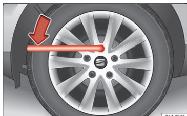
Fig. 80 Hjulskit: løsning af hjulbolte
