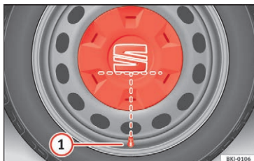
Fig. 76 Korrekt placering af hjulkapsel til stålfælg
