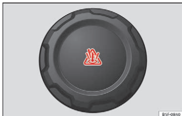
Fig. 66 I motorrummet: dæksel på motorkølevæskeekspansionsbeholder
