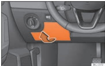
Fig. 63 Instrumentpanelet i førersiden: afdækning på sikringsboks
