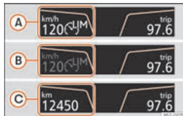
Fig. 226 På kombiinstrumentets skærm: statusvisning for hastighedsbegrænseren
