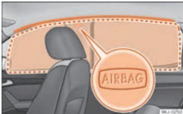
Fig. 28 Monteringssted og udløsningsområde for hovedairbag
