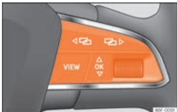
Fig. 126 Højre side af multifunktionsrattet: betjenings-elementer til menuer og informationer i kombiinstrumentet.
