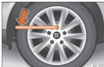
Fig. 72 Hjulskift: løsning af hjulbolte
