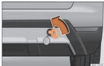
Fig. 77 Højre side af den bageste stødfanger: slæbeøjje
