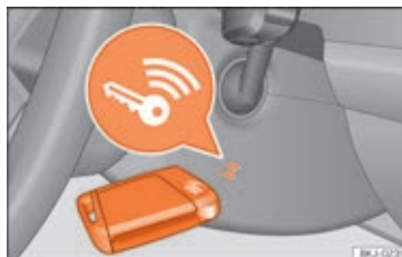
Fig. 216 På højre side af ratstamme: nødstart
