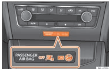
Fig. 95 Midterste del af instrumentpanelet: kontrollampe til frakoblet frontairbag til forsædepassageren
