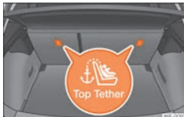
Fig. 38 Placering af Top Tether-ringene bag på bagsædet
