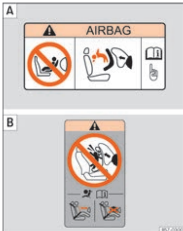
Fig. 31 Airbagmærkat – version 2: på solskærmen til forsædepassageren A og på passagerdørrammen bagest B
