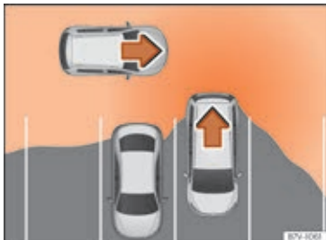
Fig. 245 Skematisk billede af udkørselsassistenten: overvåget område for bil, der kører ud fra parkeringsbåse
