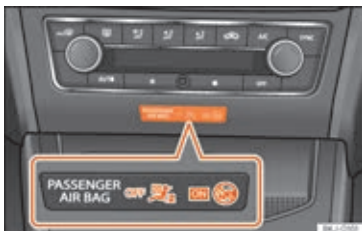
Fig. 25 Midterste del af instrumentpanelet: kontrollampe til frakoblet frontairbag til forsædepassageren
