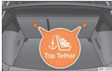
Fig. 34 Placering af Top Tether-ringene bag på bagsædet
