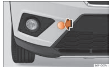
Fig. 97 Højre side af den forreste stødfanger: aftrækning af afdækning
