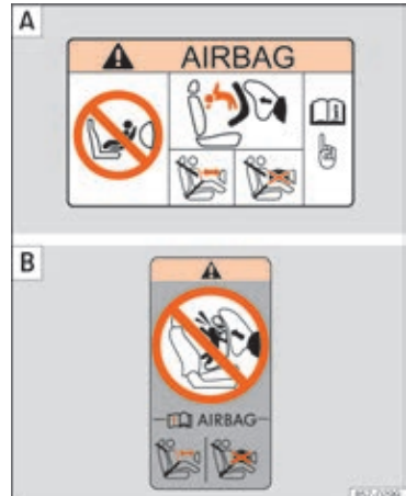
Fig. 30 Airbagmærkat - version 1: på solskærmen til forsædepassageren [A] og på passagerdørrammen bagest [B]
