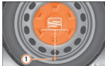
Fig. 70 Korrekt placering af hjulkapsel til stålfælg
