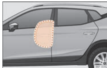
Fig. 27 Fuldt oppustede sideairbags i venstre side af bilen
