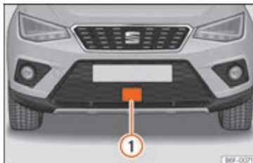
Fig. 230 I forreste stødfanger: radarsensor
