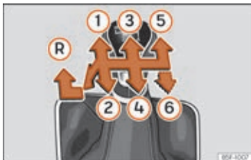
Fig. 51 Skiftediagram i forbindelse med 5-trins eller 6-trins manuel gearkasse
