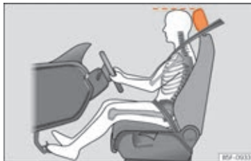
Fig. 84 Korrekt indstilling af førerens hovedstøtte
