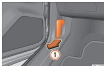
Fig.11 Udløserarm i fodrummet i førersiden
