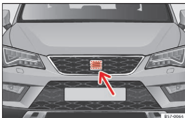
Fig. 177 I området ved bilens front bag SEAT logoet registrer området: radarsensor
