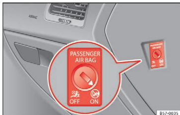
Fig. 93 Kontakt til forsædepassagerens frontairbag
