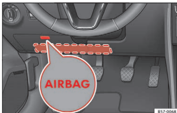
Fig. 23 I førersiden: knæairbaggens placering
