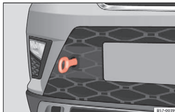
Fig. 74 Højre side af den forreste stødfanger: slæbebøjle, der er skruet i
