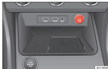
Fig. 148 I midterkonsollen bag: 12-volts-stikdåse
