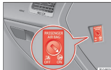
Fig. 22 Kontakt til forsædepassagerens frontairbag
