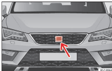
Fig. 185 I området ved bilens front bag SEAT logoet: radarsensor
