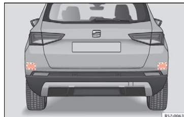
Fig. 193 Område bag bilen: områder for radarsensorerne
