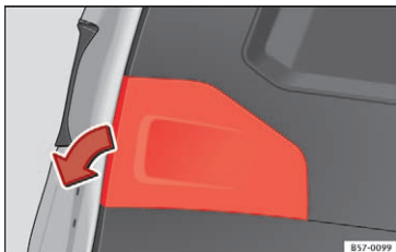
Fig. 110 Åben bagklap: fjernelse af afdækning
