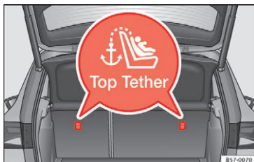
Fig. 32 Placering af Top Tether-ringene bag på bagsædet
