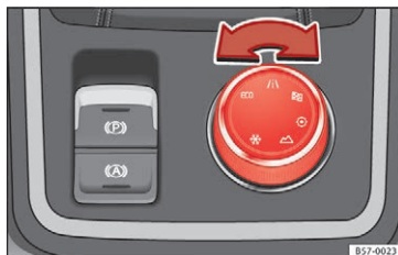
Fig. 197 Midterkonsollen: drejeknap (Driving Experience)
