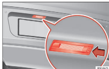
Fig. 112 I stødfangeren bagest: nummerpladelygte
