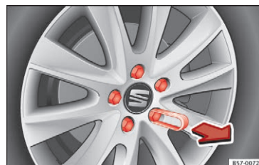
Fig. 69 Hjul: hjulbolte med dækkapper
