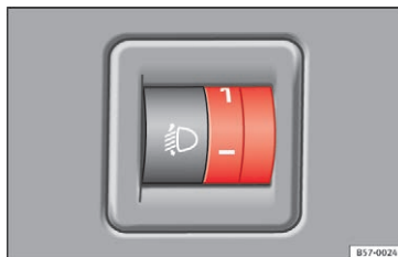
Fig. 136 Ved siden af rattet: indstillingshjul til lyslængderegulering
