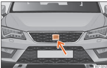
Fig. 233 I området ved bilens front bag SEAT logoet: radarsensor
