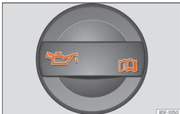
Fig. 282 Dækslet på påfyldningsåbningen til motorolie i motorrummet
