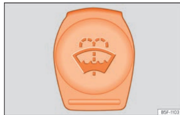
Fig. 286 I motorrummet: dæksel på sprinklervæskebeholder
