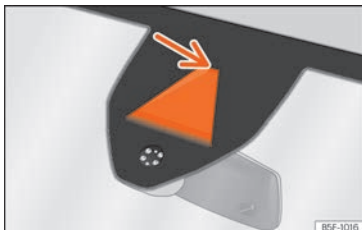
Fig. 239 På forruden: vognbaneassistentens kamerafelt
