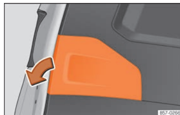
Fig. 63 Åben bagklap: fjernelse af afdækning
