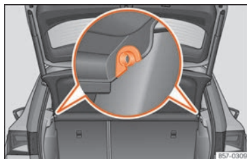
Fig. 133 I bagagerummet: af- og påmontering af bagagerumsafdækning
