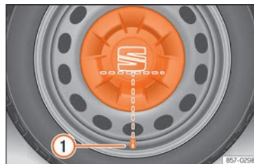
Fig. 35 Korrekt placering af hjulkapsel til stålfælg
