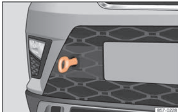
Fig. 48 I højre side af den forreste stødfanger: slæbeøje, der er skruet i
