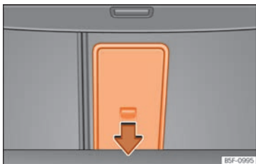
Fig. 143 I bagagerummet: åbning af skiklap
