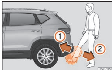
Fig. 103 Bagklap med sensorstyret åbning (Easy Open)
