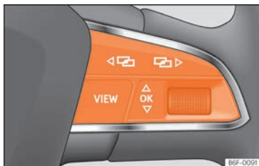
Fig. 80 Højre side af multifunktionsrattet: betjeningselementer til menuer og informationer i kombiinstrumentet.
