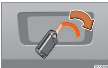
Fig. 105 Udsnit af bagagerummet: nødoplåsning
