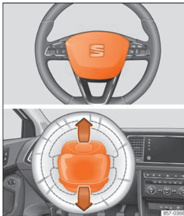
Fig. 15 Førerens frontairbag er placeret i rattet.
