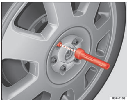
Fig. 136 Hjulskift: Den indvendige sekskant i skruetrækkerens håndtag bruges til at dreje hjulboltene, når de er løsnet.
