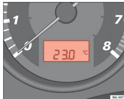
Fig. 35 Display i instrumentpanelet: udetermometer
