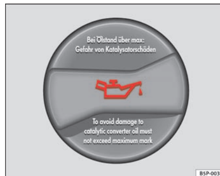
Fig. 124 I motorrummet: oliepåfyldningsdæksel
