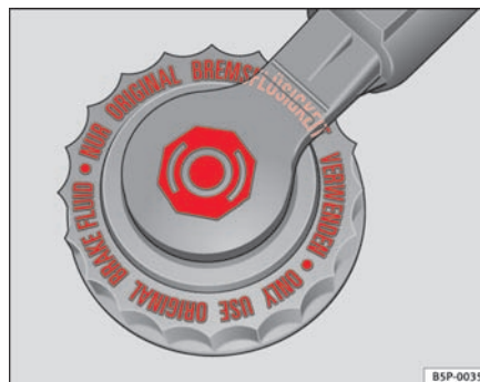
Fig. 128 I motorrummet: afdækning til bremsevæskebeholderen
