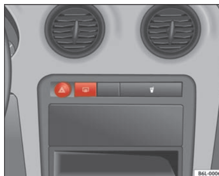
Fig. 57 Instrumentpanel: kontakt til elbagrude
