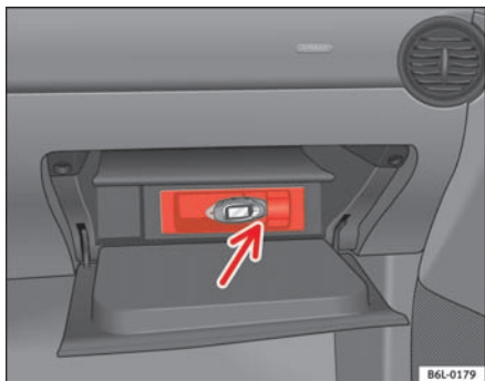
Fig. 85 USB*-tilslutningsstik i handskerummet
