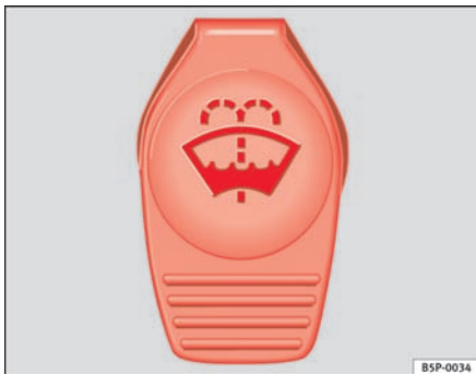
Fig. 126 I motorrummet: dæksel til sprinklervæskebeholder
