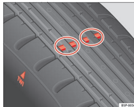
Fig. 129 Slidindikatorer til dækprofil
