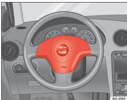
Fig. 16 Førerens airbag er placeret i rattet.
