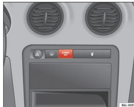
Fig. 25 Advarselsslampe i midterkonsollen til visning af om forsædepassagerens airbag er frakoblet
