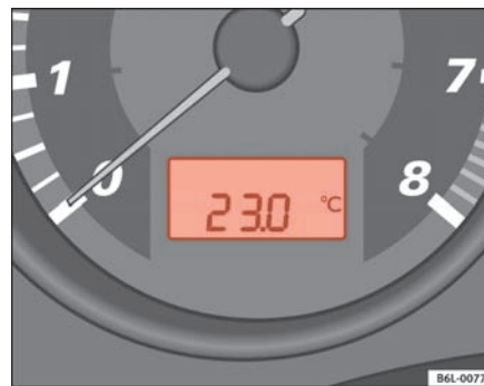
Fig. 37 Display i instrumentpanelet: udtermometer
