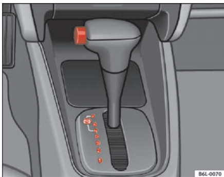
Fig. 98 Udsnit af midterkonsollen: gearvælger i biler med automatisk gearkasse
