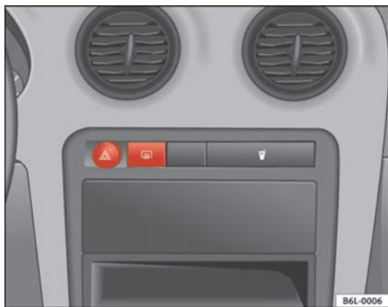
Fig. 58 Udsnit af instrumentpanelet: knap til havariblink
