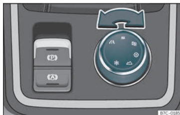
Fig. 225 Midterkonsollen: drejeknap (Driving Experience)
