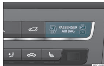
Fig. 82 Instrumentpanel: kontrollampe til frakoblet frontairbag til forsædepassager
