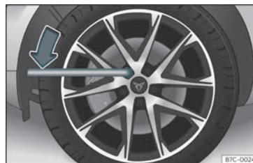
Fig. 61 Hjul: løsning af hjulbolte
