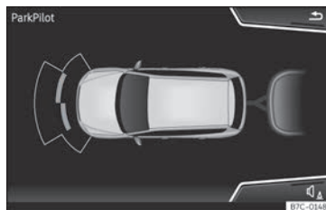
Fig. 236 Parkeringshjælps skærmvisning ved kørsel med anhænger.
