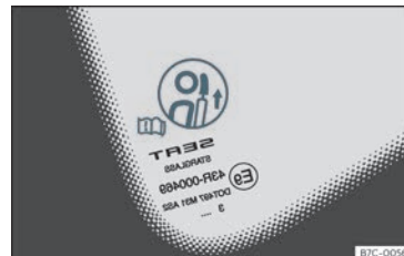
Fig. 74 Advarselmærkat vedr. hovedstøtteindstilling
