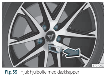
Fig. 59 Hjul: hjulbolte med dækkapper
