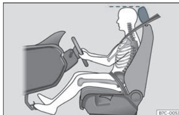
Fig. 71 Korrekt indstilling af førerens hovedstøtte
