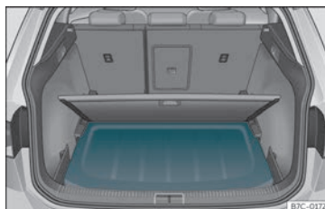
Fig. 138 I bagagerummet: isætning af bagagerumsafdækning
