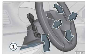
Fig. 19 Betjeningsarm nederst på ratstammen i venstre side
