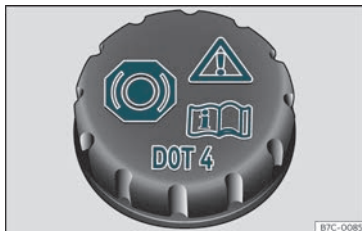
Fig. 52 I motorrummet: dæksel på bremsevæskebeholder
