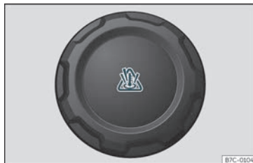
Fig. 51 I motorrummet: dæksel på motorkølevæskeexpansionsbeholder
