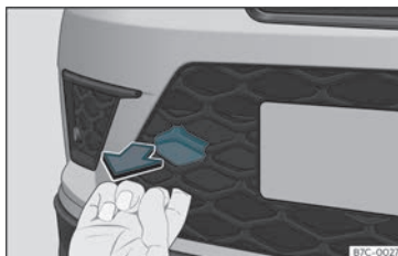
Fig. 84 I højre side af den forreste stødfanger: fjernelse af afdækning
