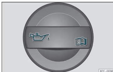
Fig. 249 Dæksel på påfyldningsåbningen til motorolie i motorrummet
