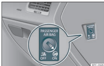
Fig. 22 Kontakt til forsædepassagerens frontairbag
