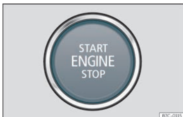
Fig. 35 I nederste del af midterkonsollen: start-knap
