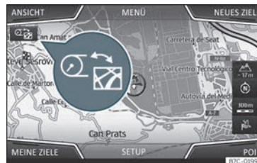
Fig. 100 Infotainmentsystem: knap til kortoverførsel
