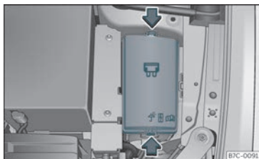
Fig. 90 I motorrummet: afdækning på sikringsboks
