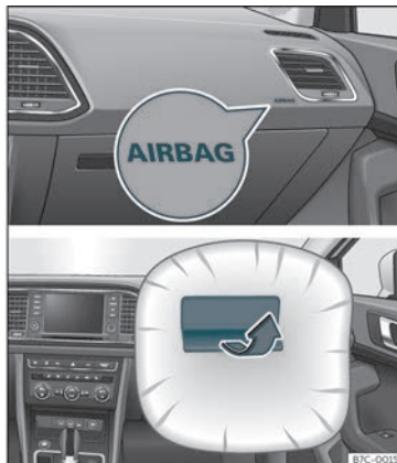
Fig. 21 Forsædepassagerens frontairbag i instrumentpanelet
