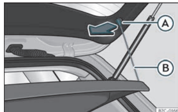
Fig. 135 I bagagerummet: af- og påmontering af bagagerumsafdækning
