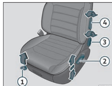
Fig. 13 Forsæder: manuel sædeindstilling
