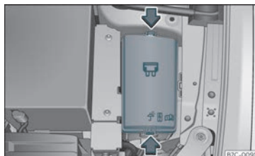
Fig. 55 I motorrummet: afdækning på sikringsboks
