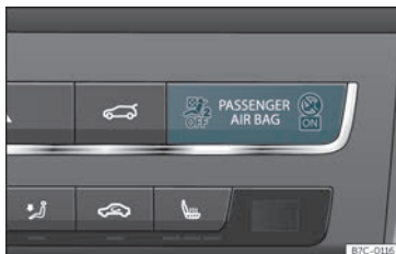
Fig. 23 Instrumentpanel: kontrollampe til frakoblet frontairbag til forsædepassager
