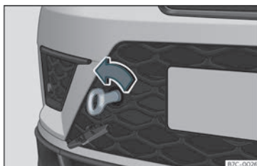
Fig. 85 I højre side af den forreste stødfanger: slæbeøj, der er skruet i
