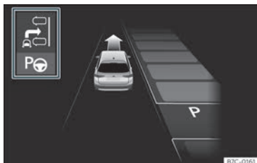
Fig. 228 På kombiinstrumentets skærm: visning af parkeringsstyringsassistenten med begrænset visning.
