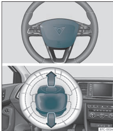
Fig. 20 Førerens frontairbag er placeret i rattet.
