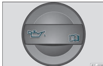
Fig. 50 Dæksel på påfyldningsåbningen til motorolie i motorrummet
