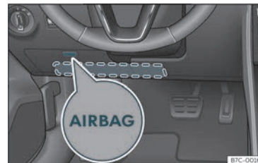
Fig. 24 I førersiden: knæairbagens monteringssted
