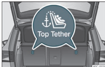
Fig. 34 Placering af Top Tether-ringene bag på bagsædet
