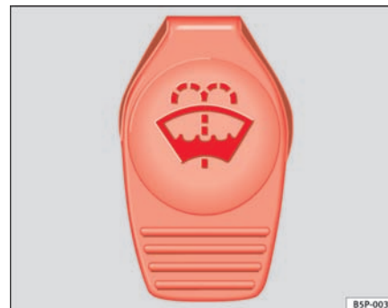
Fig. 128 I motorrummet: dæksel til sprinklervæskebeholder
