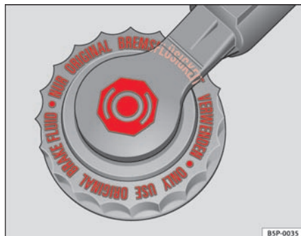
Fig. 131 I motorrummet: afdækning til bremsevæskebeholderen
