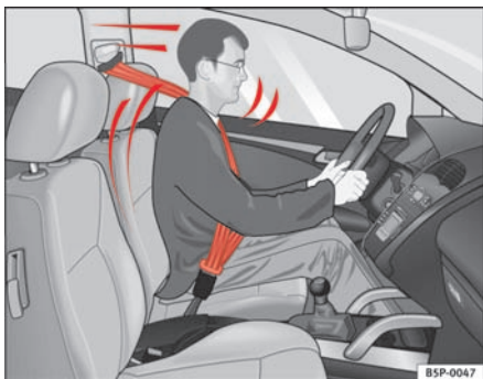
Fig. 10 En fører beskyttet af en korrekt spændt sikkerhedsseler under en pludselig opbremsning
