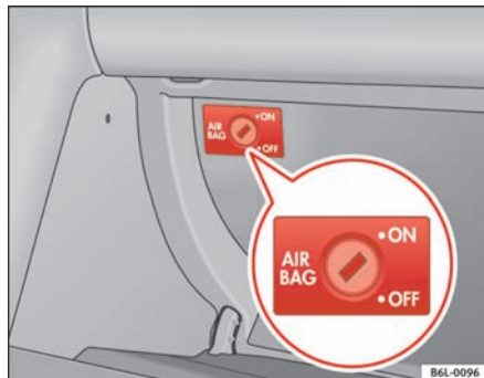
Fig. 24 I handskerummet sidder der en nøglekontakt til fra- og tilkobling af forsædepassagerens airbag.
