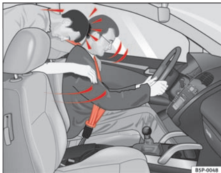
Fig. 9 Bagsædepassageren, som ikke har sikkerhedssele på, kastes voldsomt fremad og rammer føreren, som har sikkerhedssele på.
