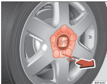
Fig. 134 Hjulskift: Sådan tages centerkapslerne af.
