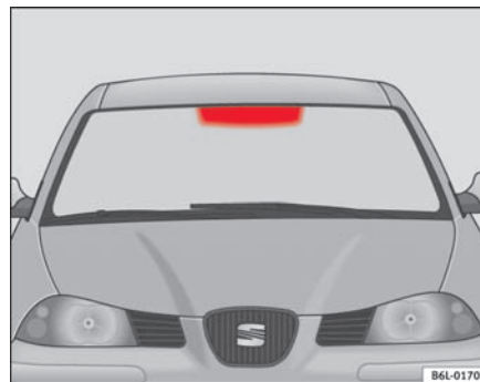
Fig. 68 Forrude med metalbelægning (rødt område)
