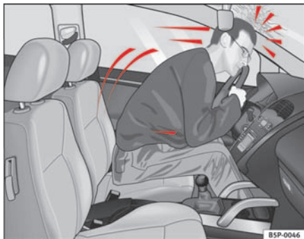
Fig. 8 En fører, som ikke har sikkerhedssele på, kastes voldsomt fremad.
