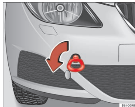
Fig. 149 Montering af slæbebøjle bag på bilen
