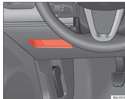
Fig. 73 Opbevaringsrum i førersiden
