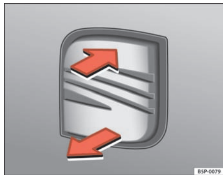
Fig. 45 Bagklap: åbning udefra
