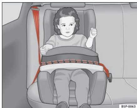
Fig. 26 Børnesæde monteret i kørselsretningen på bagsædet gruppe 1
