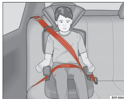
Fig. 27 Børnesæde monteret i kørselsretningen på bagsædet
