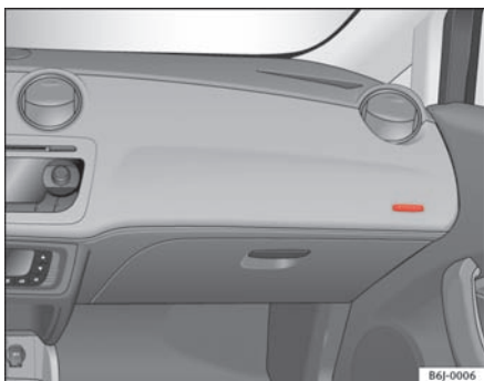
Fig. 17 Forsædepassagerens airbag er placeret i instrumentpanelet.
