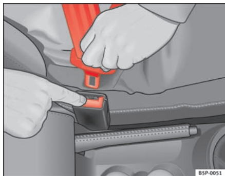
Fig. 15 Sådan frigør du låsetappen fra seletåsen.
