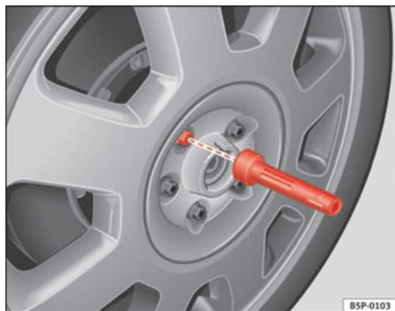
Fig. 125 Hjulskift: indvendig sekskant, som boltene kan skrues ud og i med
