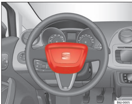
Fig. 16 Førerens airbag er placeret i rattet.
