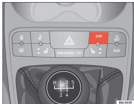
Fig. 91 Udsnit af midterkonsollen: ESP-knap
