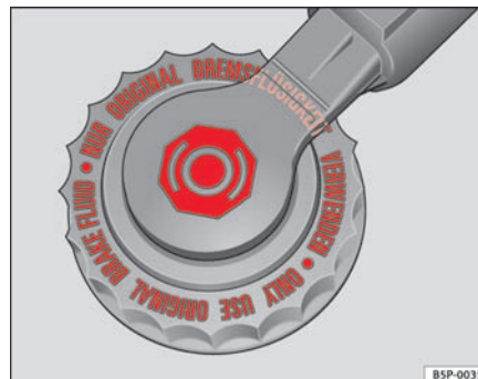
Fig. 118 I motorrummet: afdækning til bremsevæskebeholderen
