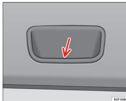
Fig. 46 Udsnit af bagklappens indvendige beklædning: greb til at lukke bagklappen med
