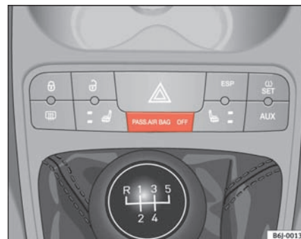
Fig. 24 Kontrollampe i midterkonsollen, der viser, om forsædepassagerens airbag er frakoblet
