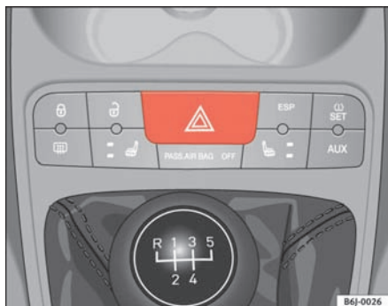
Fig. 55 Midterkonsol: knap til havariblink
