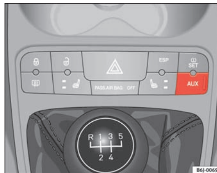
Fig. 81 AUX-stik i midterkonsollen (afhængigt af bilens udstyr)
