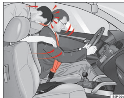
Fig. 9 En bagsædepassager, som ikke har sikkerhedssele på, kastes voldsomt fremad og rammer føreren, som har sikkerhedssele på.
