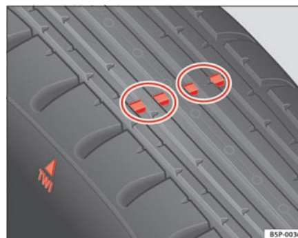
Fig. 119 Slidindikatorer til dækprofil
