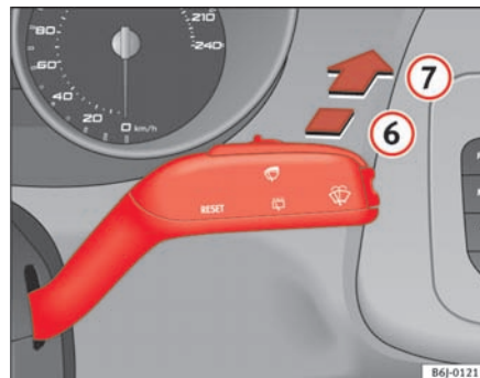
Fig. 62 Betjeningsarm til viskere og sprinklere: bagrudevisker
