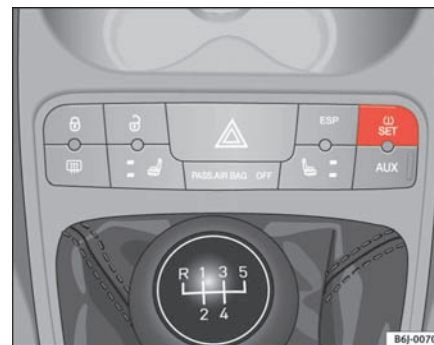
Fig. 37 Midterkonsollen: knap til dækkontrolvisning
