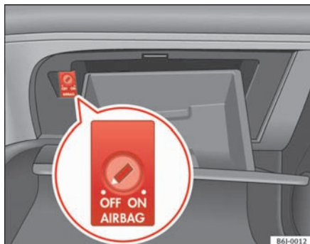
Fig. 23 I handskerummet: nøglekontakt til til- og frakobling af forsædepassagerens airbag
