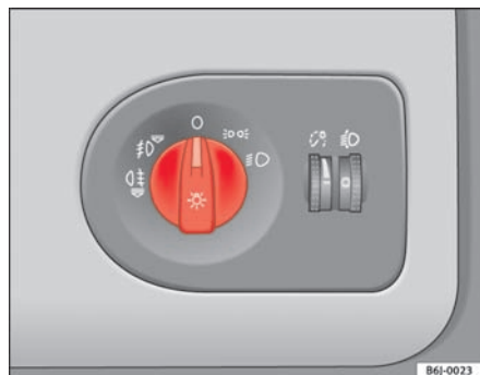
Fig. 51 Udsnit af instrumentpanelet: kontakt til lys, tågeforlygter og tågebaglygte
