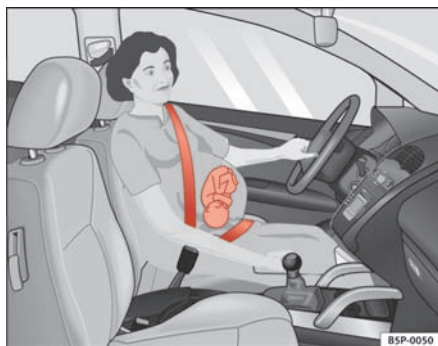
Fig. 14 Selens placering på gravide
