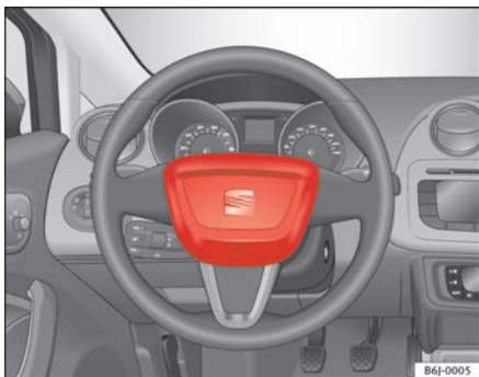
Fig. 16 Førerens airbag er placeret i rattet.
