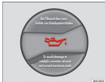
Fig. 126 Dæksel på påfyldningsåbningen til motorolie i motorrummet
