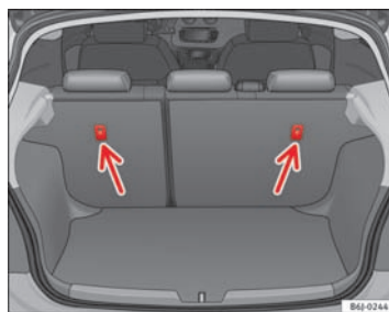
Fig. 27 Placering af Top Tether-ringene bag på bagsædet
