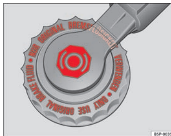
Fig. 133 I motorrummet: bremsevæskebeholders afdækning
