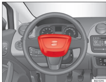
Fig. 16 Førers frontairbag er placeret i rattet.
