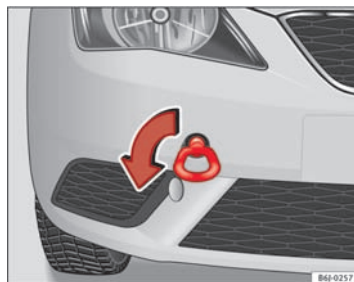
Fig. 170 Sådan skrues slæbebøjlet i forrest på bilen.
