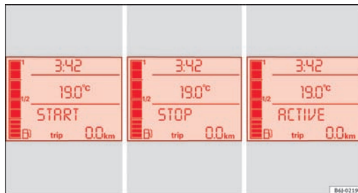
Fig. 102 Visning i kombiinstrumentets display ved aktiveret start-stop-funktion
