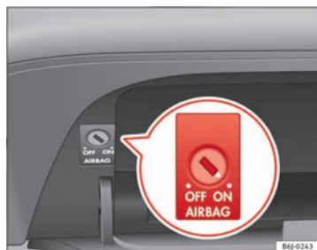
Fig. 21 I handskerummet: nøglekontakt til frakobling af forsædepassagerens frontairbag
