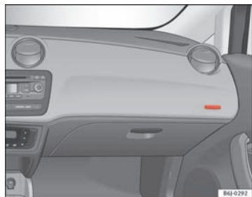
Fig. 17 Forsædepassagerens frontairbag er placeret i instrumentpanelet.
