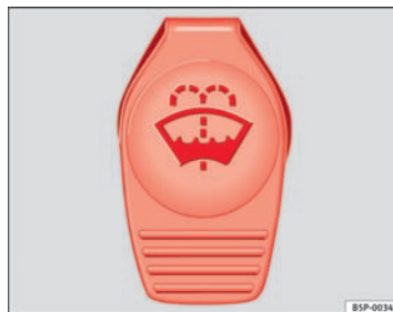
Fig. 128 I motorrummet: dæksel på sprinklervæskebeholderen
