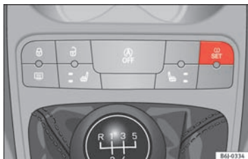
Fig. 125 Midterkonsollen: knap til dækkontrolvisning
