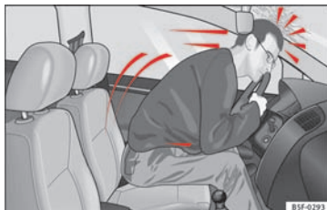
Fig. 80 En fører, der ikke har sikkerhedssele på, bliver kastet fremad.
