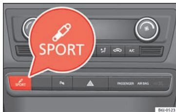
Fig. 183 I midterkonsollen: knap til indstilling af systemet SEAT Drive Profile
