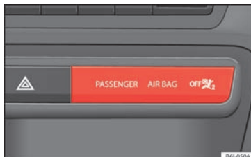
Fig. 85 Midterste del af instrumentpanelet: kontrollampe til frakoblet frontairbag til forsædepassageren
