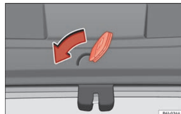
Fig. 5 IBIZA ST: nødoplåsning af bagklap
