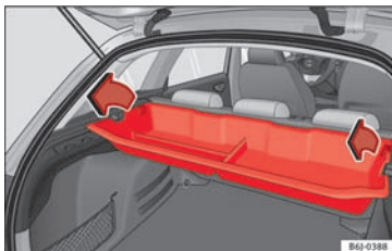
Fig. 160 Bagagerum: afmontering af opbevaringsrum
