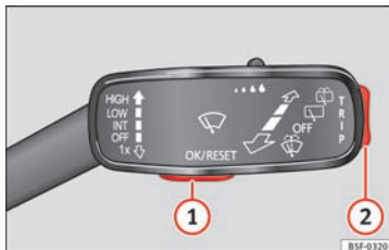
Fig. 37 Betjeningsarm til viskere: styreknap-per
