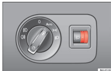
Fig. 134 Instrumentpanel: indstillingshjul til lyslængderegulering
