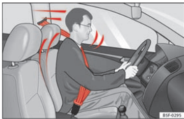
Fig. 79 Hvis sikkerhedsselen er spændt kor-rekt, bliver føreren ikke kastet frem ved en pludselig opbremsning.
