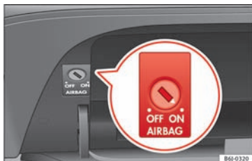
Fig. 84 I handskerummet: nøglekontakt til fra- og tilkobling af forsædepassagerens frontairbag
