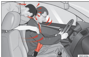
Fig. 81 En bagsædepassager, der ikke har sikkerhedssele på, bliver kastet fremad og ind i den fastspændte fører.
