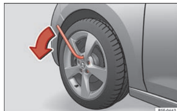
Fig. 64 Hjul: løsning af hjulbolte
