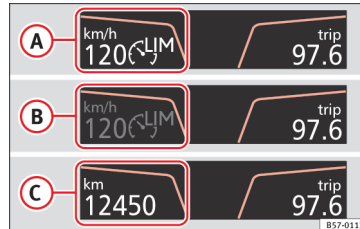
Fig. 154 I kombiinstrumentets display: statusvisning for hastighedsbegrænseren
