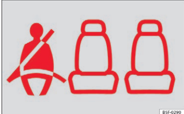
Fig. 82 Kombiinstrument: indikator for, at højre bagsædeplads er optaget, og at den tilhørende sikkerhedssele er spændt
