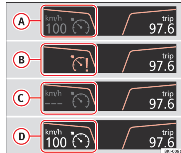
Fig. 153 I kombiinstrumentets display: fartpilots forskellige tilstande
