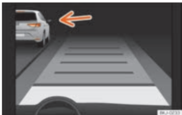
Fig. 240 På kombiinstrumentets skærm: ACC aktiv, køretøj registreret i venstre side
