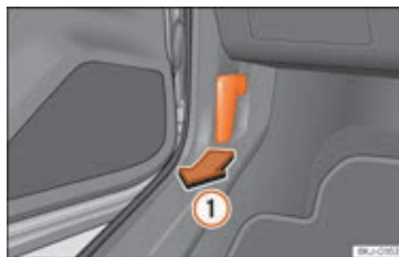
Fig.11 Udløserarm i fodrummet i førersiden
