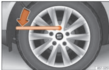
Fig. 74 Hjulskift: løsning af hjulbolte
