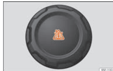
Fig. 61 I motortrummet: dækslet på motorkølevæskeekspansionsbeholder
