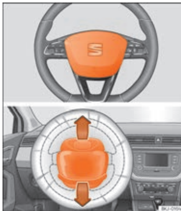
Fig. 23 Førerens frontairbag er placeret i rattet.
