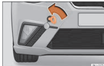
Fig. 78 Højre side af den forreste stødfanger: slæbeøj
