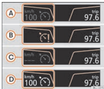
Fig. 227 Kombiinstrumentets skærm: fartpilots forskellige tilstande
