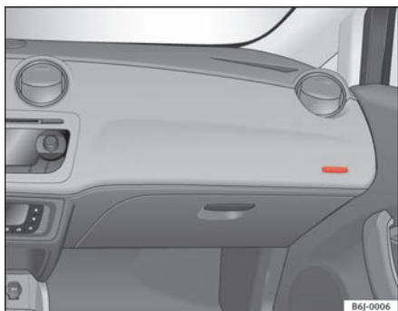
Fig. 17 Forsædepassagerens frontairbag er placeret i instrumentpanelet.
