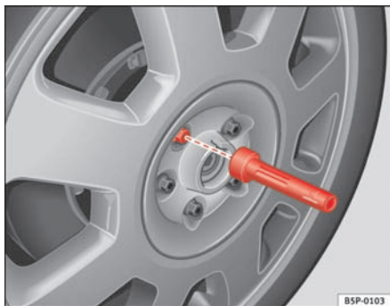
Fig. 135 Hjulskift: indvendig sekskant, som boltene kan skrues ud og i med
