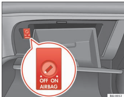
Fig. 21 I handskerummet: nøglekontakt til til- og frakobling af forsædepassagerens airbag
