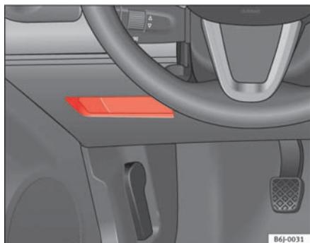
Fig. 72 Opbevaringsrum i førersiden
