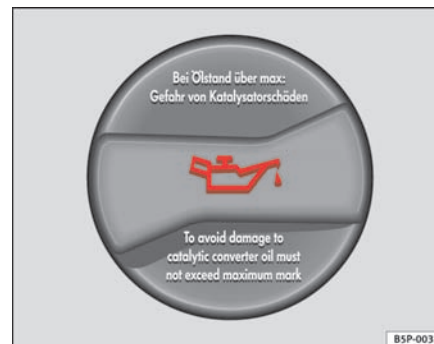
Fig. 123 Dæksel på påfyldningsåbningen til motorolie i motorrummet
