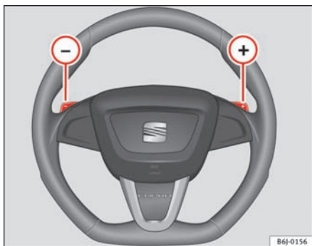
Fig. 108 Rat med skifte-kontakter til automatisk gearkasse
