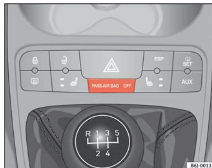
Fig. 22 Kontrollampe, der viser om forsædepassagerens airbag er frakoblet
