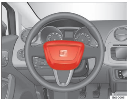
Fig. 16 Førerens frontairbag er placeret i rattet.
