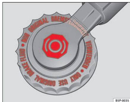
Fig. 128 I motorrummet: bremsevæskebeholderens afdækning
