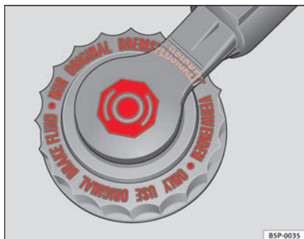
Fig. 128 I motorrummet: bremsevæskebeholderens afdækning
