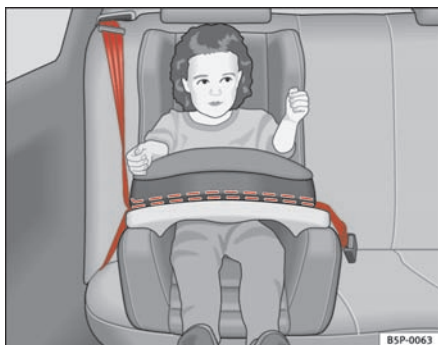
Fig. 24 Børnesæde monteret i kørselsretningen på bagsædet – gruppe 1
