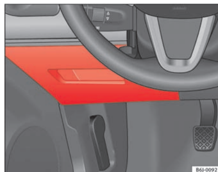
Fig. 137 Sikringer i instrumentpanelet
