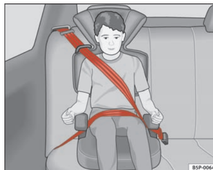
Fig. 25 Børnesæde monteret i kørselsretningen på bagsædet
