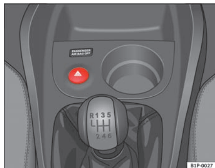
Fig. 77 Udsnit af instrumentpanelet: knap til havariblink
