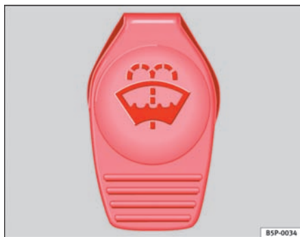
Fig. 140 I motorrummet: sprinklerbeholderens dæksel
