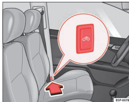
Fig. 66 Knap til deaktivering af kabineovervågningen
