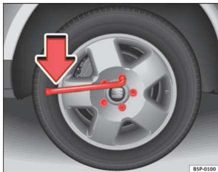
Fig. 148 Hjulskift: Sådan løsnes hjulboltene.
