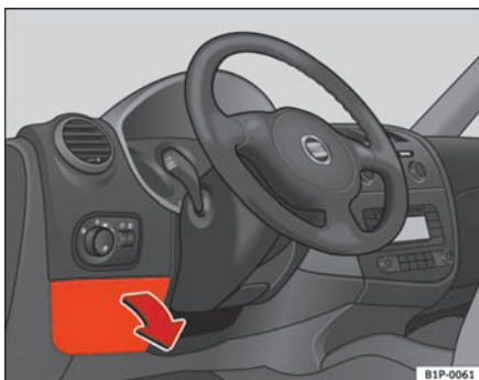
Fig. 153 Venstre side af instrumentpanelet: afdækning på sikringsboks
