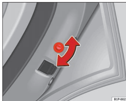
Fig. 61 Børnesikring i højre dør
