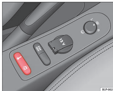
Fig. 59 Udsnit af midterkonsollen: centrallåskontakter
