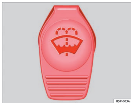
Fig. 140 I motorrummet: sprinklerbeholderens dæksel
