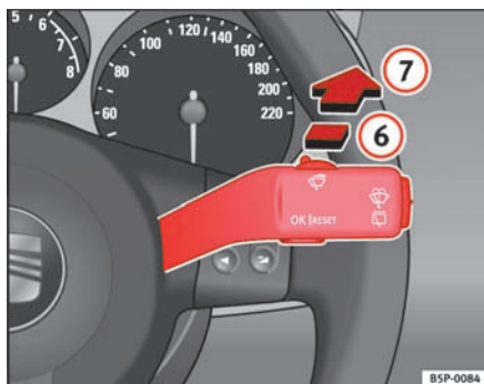
Fig. 86 Betjeningsarm til viskere og sprinklere: bagrudevisker
