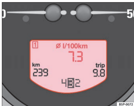
Fig. 39 Display i kombiinstrumentet: gennemsnitligt brændstofforbrug
