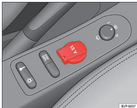
Fig. 101 Stikdåse i midterkonsol foran
