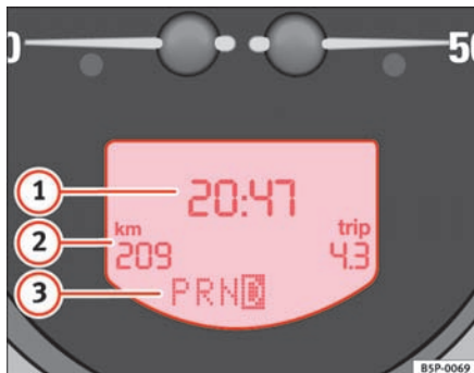
Fig. 35 Udsnit af kombiinstrumentet: display med forskellige visninger
