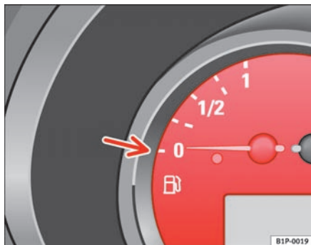
Fig. 33 Udsnit af kombi-instrumentet: tankmåler
