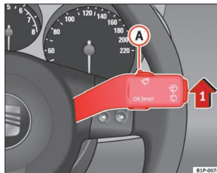
Fig. 85 Betjeningsarm til viskerne
