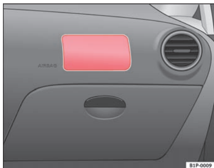
Fig. 18 Placering af frontairbaggen til forsædepassageren: i instrumentpanelet
