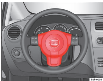
Fig. 17 Placering af frontairbaggen til føreren: i rattet
