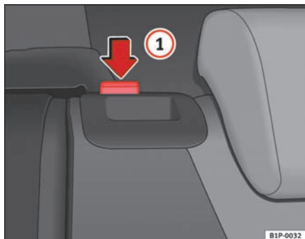
Fig. 95 Sådan klappes ryglænet op
