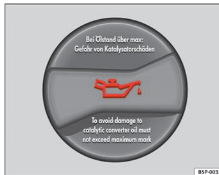
Fig. 138 Dæksel på påfyldningsåbningen til motorolie i motorrummet
