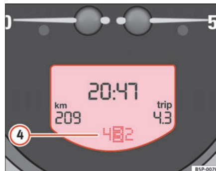
Fig. 36 Udsnit af kombiinstrumentet: display med angivelse af gear (tiptronic)
