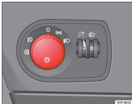
Fig. 74 Udsnit af instrumentpanelet: kontakt til lys, tågeforlygter og tågebaglygte
