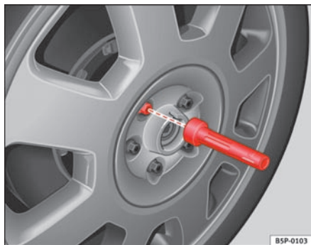
Fig. 151 Hjulsift: Indvendig sekskant, som boltene kan skrues ud og i med
