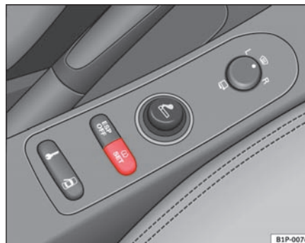
Fig. 47 Midterkonsol: knap til dæktrykssystem
