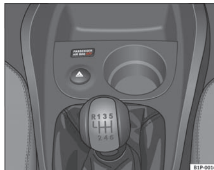
Fig. 26 Kontrollampe, der viser om forsædepassagerens airbag er frakoblet
