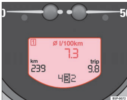
Fig. 41 Display i kombiinstrumentet: gennemsnitligt brændstofforbrug
