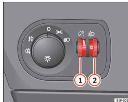
Fig. 76 Udsnit af instrumentpanelet: indstillingshjul til instrument-/kontaktlys og lyslængderegulering
