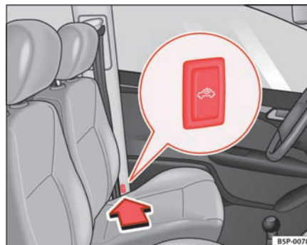
Fig. 66 Knap til deaktivering af kabineovervågningen
