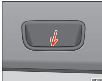
Fig. 68 Udsnit af bagklappens indvendige beklædning: greb til at lukke bagklappen med
