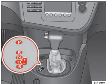
Fig. 117 Automatisk gearkasse: gearvælgerpositioner
