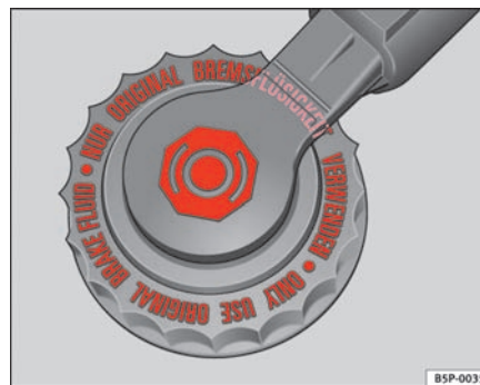
Fig. 143 I motorrummet: afdækning til bremsevæskebeholderen
