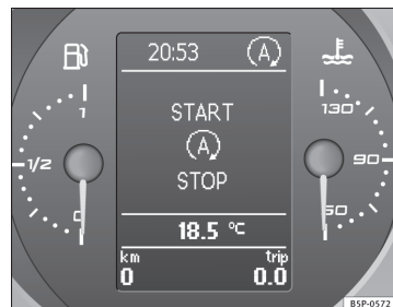
Fig. 120 Visning i kombiinstrumentets display ved aktiveret start-stop-funktion
