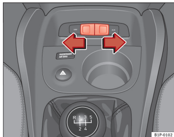
Fig. 102 Åbning af af-dækningen til stikdåsen i midterkonsollen
