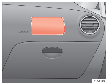
Fig. 18 Forsædepassagerens frontairbag er placeret i instrumentpanelet.
