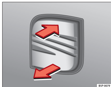
Fig. 64 Bagklap: åbning udefra
