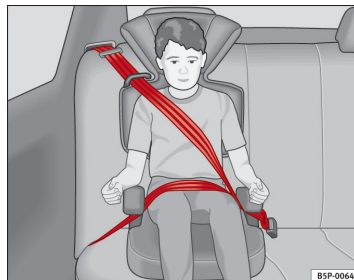
Fig. 29 Børnesæde monteret i kørselsretningen på bagsædet
