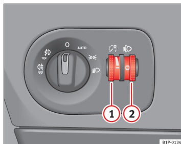
Fig. 73 På instrument-panelet: indstillingshjul til instrument-/kontaktilys og lyslængderegulering
