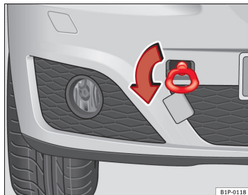
Fig. 182 Foran i højre side: Sådan skrues slæbøjjet i foran.
