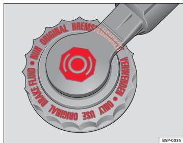
Fig. 151 I motorrummet: bremsevæskebeholderens afdækning
