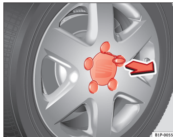
Fig. 155 Hjulskift: Sådan trækkes centerkapslen af.
