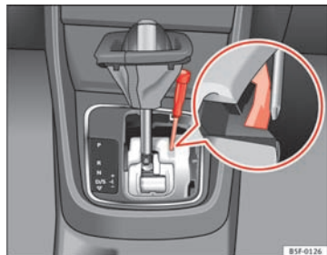
Fig. 93 Gearvælger: nødoplåsning fra parkeringsposition
