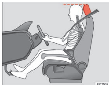
Fig. 2 Den rigtige indstilling af førerens hovedstøtte
