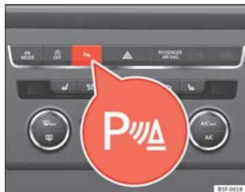
Fig. 104 Midterkonsol: knap til parkeringshjælp
