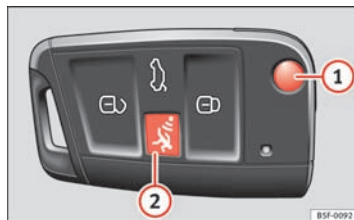
Fig. 44 Bilnøgler med alarmknap
