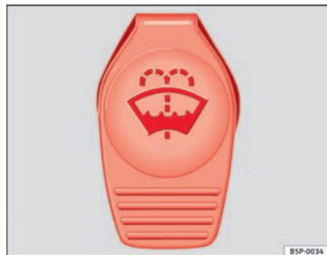
Fig. 112 Motorrum: dæksel til sprinklervæskebeholder
