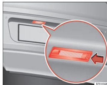
Fig. 149 I stødfangeren bagest: nummerpladelygte
