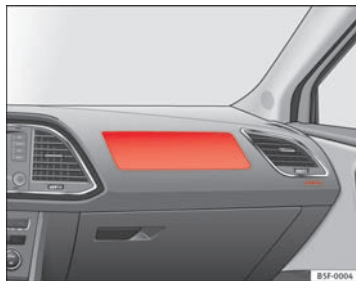
Fig. 18 Forsædepassagerens frontairbag er placeret i instrumentpanelet.
