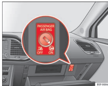
Fig. 26 Kontakt til forsædepassagerens frontairbag
