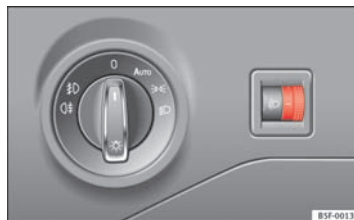
Fig. 62 Ved siden af rattet: indstillingshjul til lyslængderegulering
