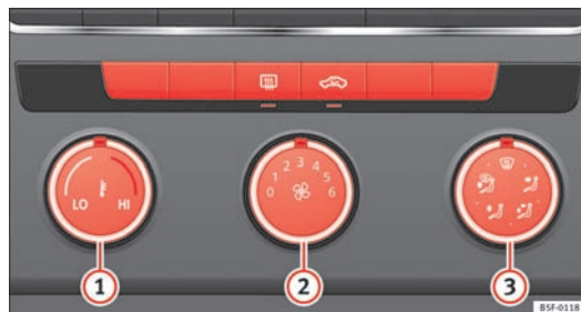
Fig. 83 I midterkonsollen: betjeningslementer til varme- og friskluftsystem
