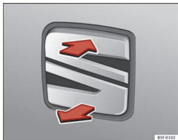
Fig. 54 Bagklap: åbning udefra
