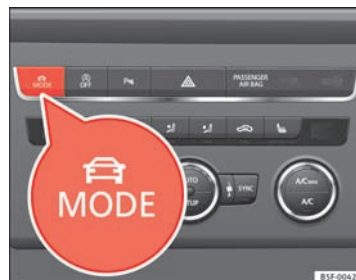
Fig. 100 Midterkonsollen: MODE -knap
