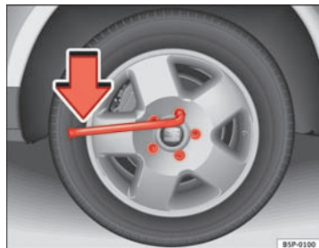
Fig. 122 Hjul: løsning af hjulbolte
