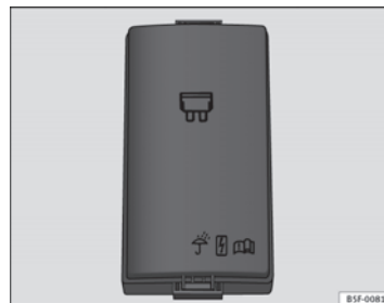
Fig. 132 Venstre side af motorrummet: afdækning til sikringer
