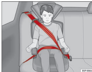
Fig. 30 Børnesæde monteret i kørselsretningen på bagsædet
