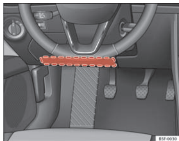
Fig. 21 I førersiden: placering af knæairbag
