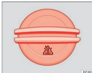
Fig. 110 I motorrummet: dæksel på kølevæskebeholder
