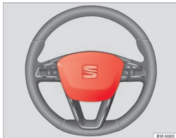
Fig. 17 Førerens frontairbag er placeret i rattet.
