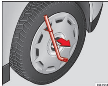
Fig. 119 Afmontering af hjulkapsel fra hjul
