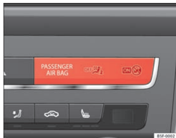
Fig. 16 Kontrollampe i instrumentpanelet til frakoblet frontairbag til forsædepassageren
