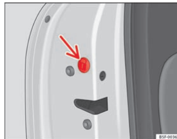
Fig. 53 Nødlåsning af dør
