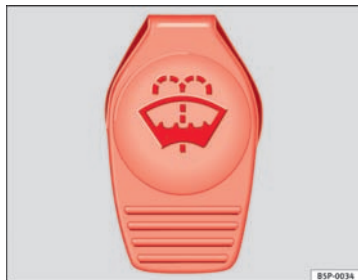
Fig. 68 I motorrummet: dæksel på sprinklervæskebeholderen
