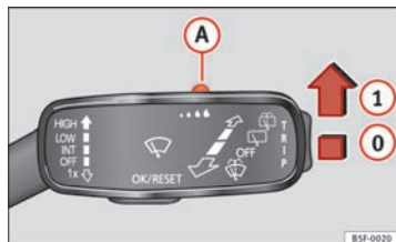
Fig. 66 Betjeningsarm til viskerne: indstilling af regnsensor (A)
