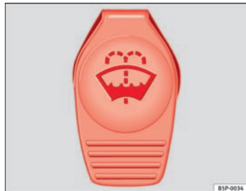
Fig. 112 Motorrum: dæksel til sprinklervæ- skebeholder
