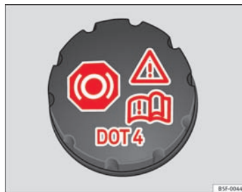
Fig. 111 I motorrummet: dæksel på bremsevæskebeholder
