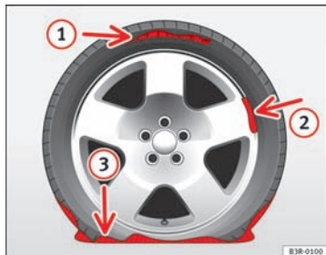
Fig. 117 Dæk: skader, der ikke kan repareres
