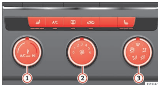
Fig. 82 I midterkonsollen: manuelle betjeningslementer til airconditionanlæg
