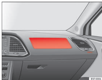
Fig. 18 Forsædepassagerens frontairbag er placeret i instrumentpanelet.
