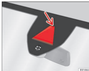
Fig. 99 På forruden: vognbaneassistentens kamerafelt
