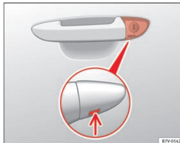
Fig. 52 Dørhåndtag på førerdøren: skjult låsecylinder
