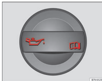
Fig. 109 Dækslet på påfyldningsåbningen til motorolie i motorrummet
