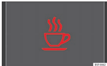
Fig. 101 I kombiinstrumentets display: symbol for træthedsregistrering
