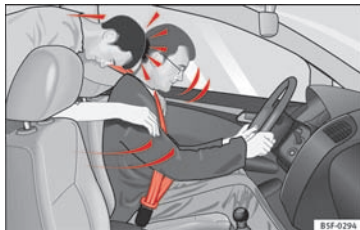
Fig. 89 Hvis sikkerhedsselen er spændt korrekt, bliver føreren ikke kastet frem ved en pludselig opbremsning.
