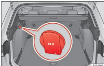
Fig. 157 Udsnit af bagagerummet: 12-volts-stikdåse (gælder kun modellen LEON ST)
