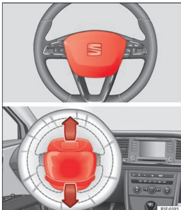
Fig. 21 Førerens frontairbag er placeret i rattet.
