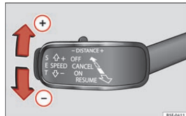
Fig. 196 På venstre side af ratstammen: tredje betjeningsarm til betjening af automatisk afstandsregulering
