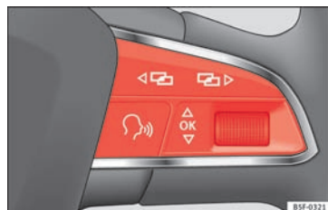
Fig. 44 Højre side af multifunktionsrat: styre- knapper
