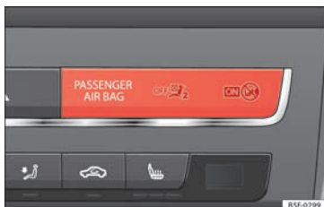
Fig. 96 Kontrollampe for frakobling af forsædepassagerens airbag
