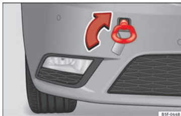
Fig. 98 Højre side af den forreste stødfanger: slæbeøj, der er skruet i
