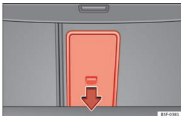
Fig. 170 I bagagerummet: åbning af skiklap
