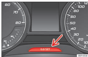
Fig. 125 Kombiinstrument: kilometertæller og nulstillingsknap
