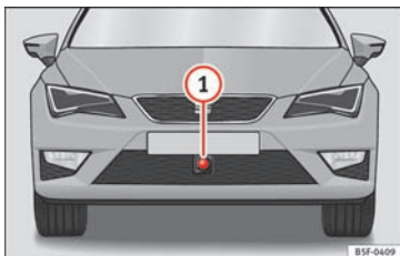
Fig. 202 I forreste stødfanger: radarsensor
