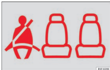
Fig. 88 Kombiinstrument: indikator for, at højre bagsædeplads er optaget, og at den tilhørende sikkerhedssele er spændt
