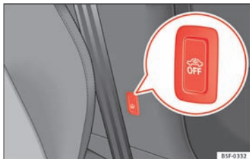
Fig. 135 Kontakt til kabine- og bortslæbningsovervågning
