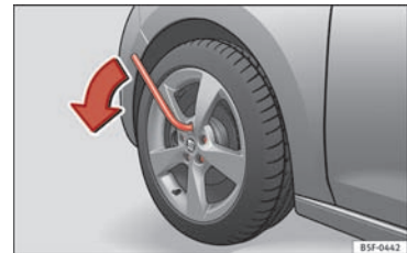
Fig. 73 Hjul: løsning af hjulbolte
