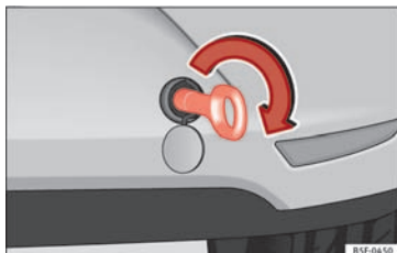
Fig. 100 Højre side af den bageste stødfanger: slæbøjle, der er skruet i
