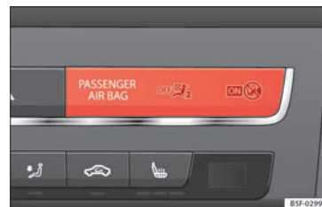
Fig. 94 Kontrollampe i instrumentpanelet til frakoblet frontairbag til forsædepassageren
