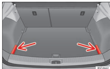
Fig. 161 I bagagerummet: afdækninger til opbevaring af bagagerumsafdækning
