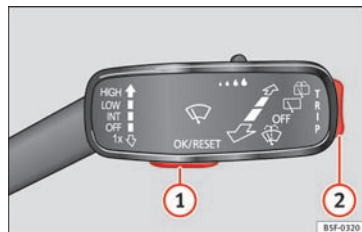
Fig. 43 Betjeningsarm til viskerne: styreknap- per
