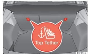
Fig. 33 Placering af Top Tether-ringene bag på bagsædet
