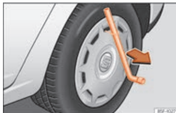
Fig. 74 Tag hjulkapslen af hjulet.
