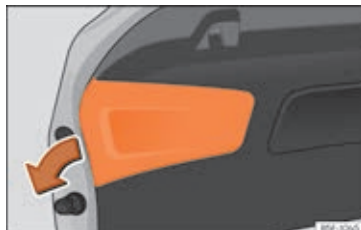
Fig. 119 Afmontering af afdækning på bagklappen
