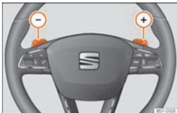
Fig. 260 Rat: gearvælger til automatisk gearkasse
