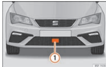
Fig. 271 I forreste stødfanger: radarsensor
