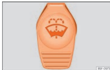
Fig. 66 I motorrummet: dæksel på sprinkler-væskebeholder
