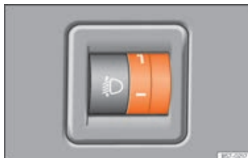
Fig. 153 Ved siden af rattet: indstillingshjul til lyslængderegulering
