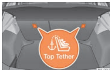
Fig. 41 Placering af Top Tether-ringene bag på bagsædet
