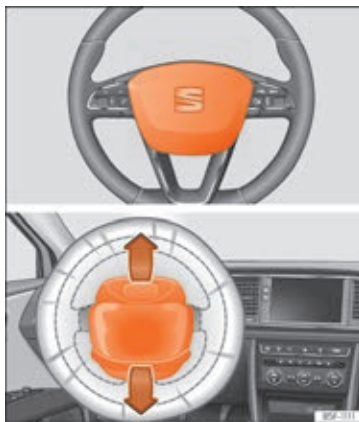
Fig. 26 Førers frontairbag er placeret i rattet.
