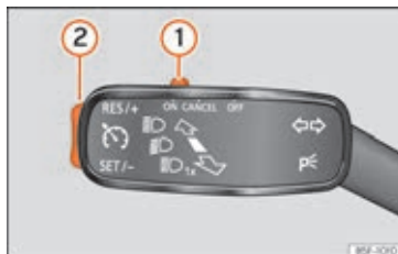
Fig. 53 På venstre side af ratstammen: kontakter og betjeningslementer til fartpiloten
