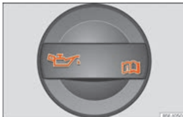
Fig. 311 Dæksel på påfyldningsåbningen til motorolie i motorrummet
