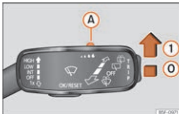
Fig. 156 Betjeningsarm til viskerne: indstilling af regnsensor A
