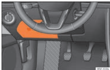
Fig. 67 Instrumentpanelet i førersiden: afdækning på sikringsboks
