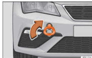
Fig. 80 Højre side af den forreste stødfanger: slæbeøje, der er skruet i
