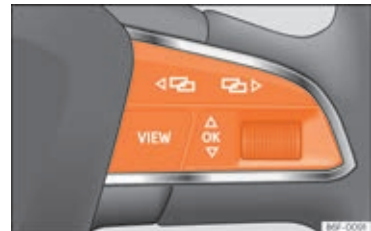
Fig. 137 Højre side af multifunktionsrattet: betjenings-elementer til menuer og informationer i kombiinstrumentet.
