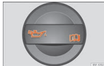
Fig. 63 Dæksel på påfyldningsåbningen til motorolie i motorrummet
