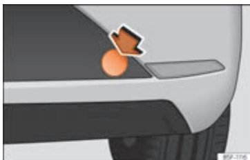
Fig. 102 Højre side af den bageste stødfanger: dækkappe
