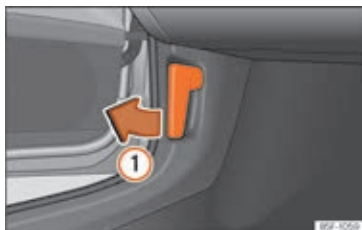
Fig. 12 Udløserarm i fodrummet i førersiden
