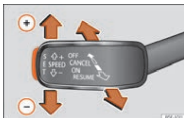
Fig. 54 På venstre side af ratstammen: tredje betjeningsarm til betjening af fartpiloten
