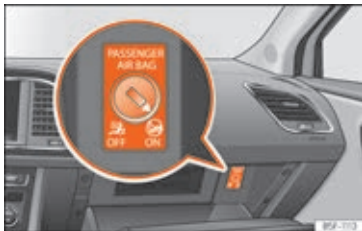
Fig. 98 Nøglekontakt til til- og frakobling af forsædepassagerens frontairbag
