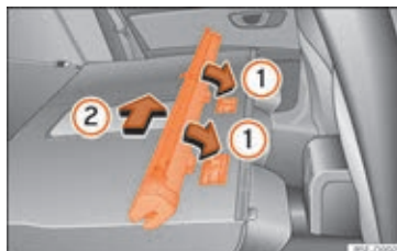
Fig. 181 Montering af netskillevæg på bagsæderyglæn
