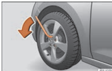
Fig. 77 Hjul: løsning af hjulbolte
