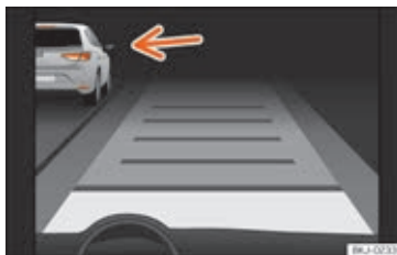
Fig. 274 I kombiinstrumentets display: ACC aktiv, køretøj registreret i venstre side
