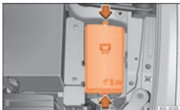
Fig. 105 I motorrummet: af-dækning på sikringsboks
