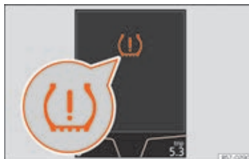
Fig. 315 Kombiinstrument: advarsel om tryktab
