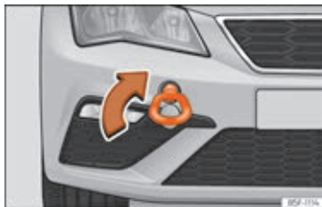
Fig. 101 Højre side af den forreste stødfanger: slæbeøjje, der er skruet i
