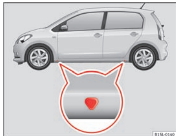
Fig. 138 Løftepunkter til donkraften
