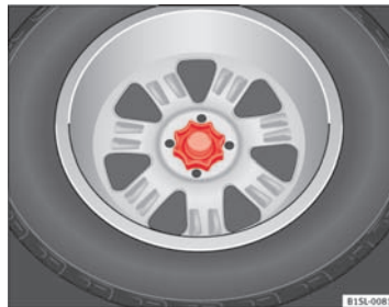
Fig. 118 I bagagerummet: håndhjul til fastgørelse af reservehjul
