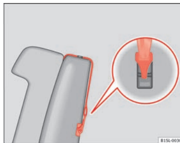
Fig. 54 Eksempel på den øverste fastgørelsesrem, der er hægtet på
