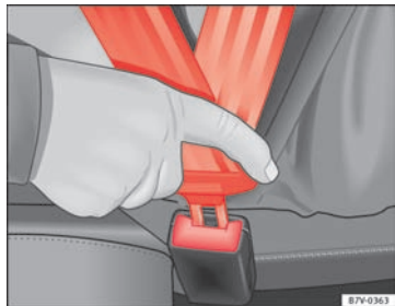
Fig. 42 Sådan sættes sikkerhedsselens låsetap ind i selelåsen.
