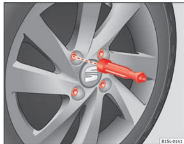
Fig. 140 Hjulsift: Sådan skrues hjulboltene af med skruetrækkerens greb.
