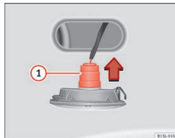
Fig. 153 Blinklygte i siden: udskiftning af pære
