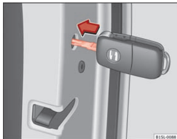
Fig. 129 Nødlåsning af bilen med bilnøglen
