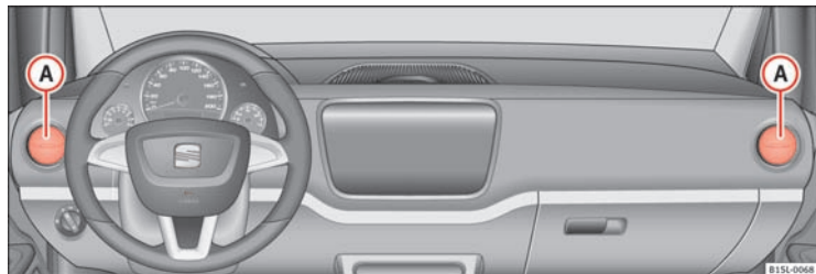
Fig. 100 I instrumentpanelet: luftdyser
