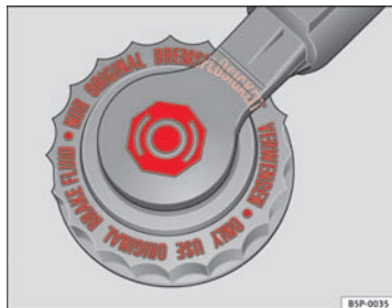
Fig. 87 I motorrummet: dæksel på bremsevæske- beholderen
