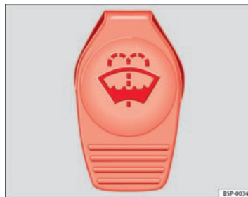
Fig. 63 I motorrummet: dæksel på sprinklervæskebeholderen
