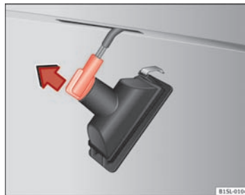
Fig. 151 Nummerpladelygte: Sådan afmonteres pæreholderen.
