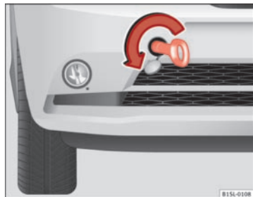
Fig. 157 I stødfangeren forrest til højre: Sådan skrues slæbøjet i.
