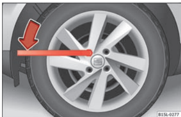
Fig. 127 Hjulskift: Sådan løsnes hjulboltene
