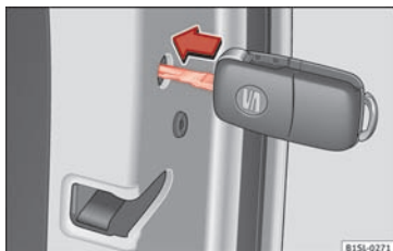
Fig. 139 Nødlåsning af bilen med bilnøglen
