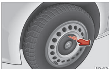
Fig. 124 Sådan trækkes centerkapslen af stålfælgen.
