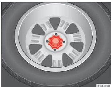
Fig. 118 I bagagerummet: håndhjul til fastgørelse af reservehjul
