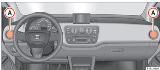
Fig. 78 I instrumentpanelet: luftdyser
