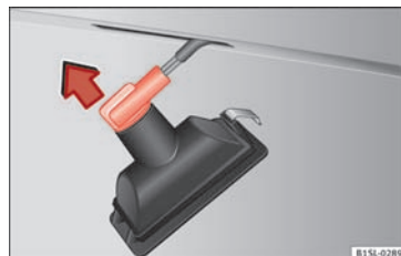
Fig. 152 Nummerpladelygte: afmontering af pæreholder
