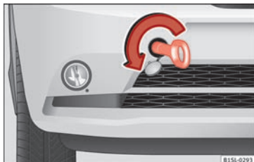
Fig. 136 I stødfangeren foran til højre: Sådan skrues slæbebøjlet i.
