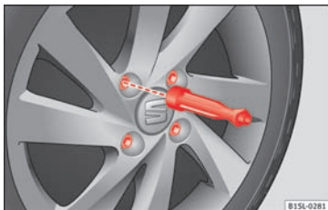
Fig. 131 Hjulsift: Sådan skrues hjulboltene ud med skruetrækkerens greb.
