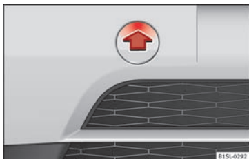
Fig. 135 I stødfangeren foran til højre: afmontering af afdækning
