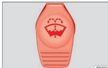
Fig. 112 I motorrummet: dæksel på sprinklervæskebeholderen »»
