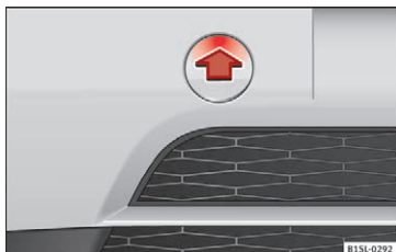
Fig. 80 I stødfangeren foran til højre: afmontering af afdækning
