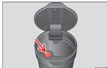
Fig. 162 Askebæger med glødeslukker, der er taget ud og åbnet
