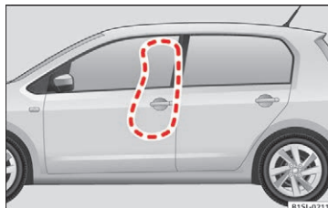
Fig. 22 På venstre side af bilen: udløsningsområde for sideairbaggen
