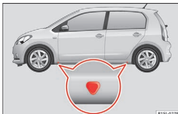
Fig. 55 Løftepunkter til donkraften
