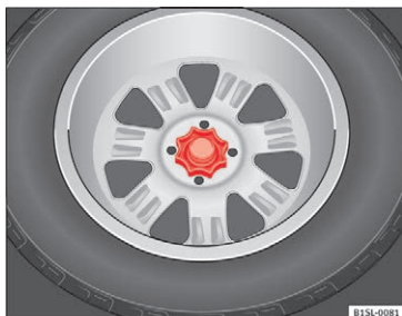
Fig. 177 I bagagerummet: håndhjul til fastgørelse af reservehjul
