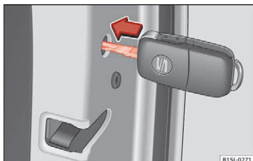
Fig. 5 Nødlåsning af bilen med bilnøglen
