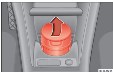
Fig. 131 I midterkonsollen foran: åbning af askebæger
