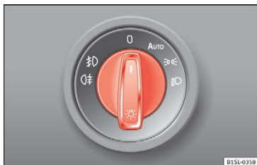
Fig. 109 Ved siden af rattet: forskellige typer lyskontakter
