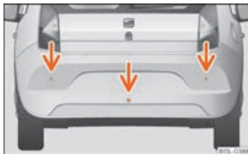
Fig. 170 Parkeringshjælpens sensorer i den bageste stødfanger
