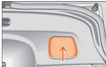
Fig. 7 Åben bagklap: greb til at lukke bagklappen med
