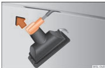
Fig. 92 Nummerpladelygte: afmontering af pæreholder
