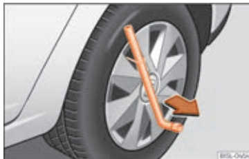
Fig. 52 Afmontering af hjulkapsel
