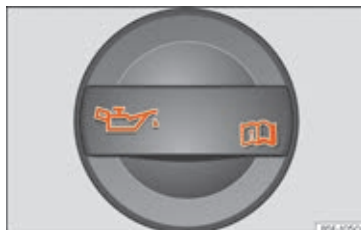
Fig. 185 I motorrummet: dæksel til påfyldningsåbningen til motorolie
