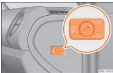
Fig. 76 I passagersiden: nøglekontakt til frakobling af forsædepassagerens frontairbag
