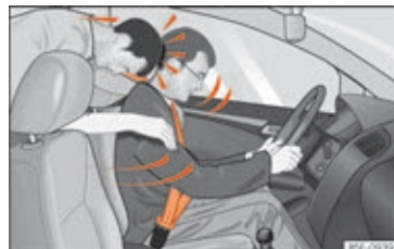
Fig. 72 En bagsædepassager, der ikke har sikkerhedssele på, bliver kastet fremad og ind i den fastspændte fører.
