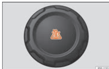
Fig. 187 I motorrummet: motorkølevæskeekspansionsbeholderens dæksel
