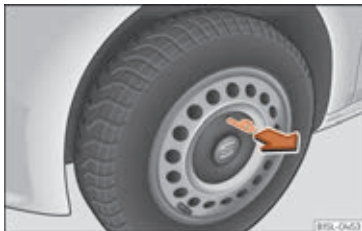
Fig. 51 Sådan trækkes centerkapslen af stål-fælgen.
