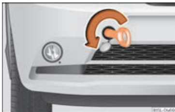
Fig. 82 I stødfangeren foran til højre: Sådan skrues slæbeøjle i.
