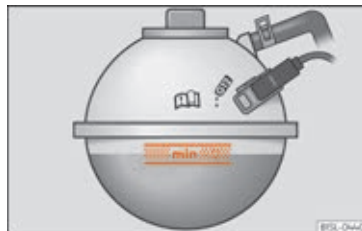
Fig. 186 I motorrummet: markering på motorkølevæskebeholderen
