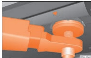
Fig. 177 Løftepunkter foran til løft af bilen med lift eller donkraft
