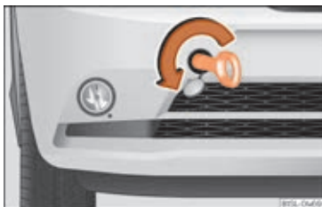
Fig. 59 Højre side af den forreste stødfanger: slæbeøjje, der er skruet i
