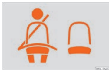
Fig. 69 Selestatusvisning for bagsædepladserne i kombiinstrumentets display
