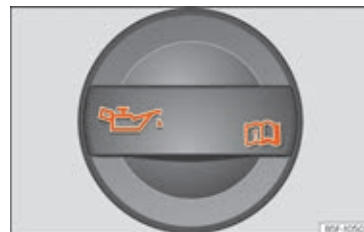
Fig. 42 Dæksel på påfyldningsåbningen til motorolie i motorrummet
