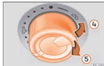
Fig. 13 I loftet: Der skal trykkes på eller trækkes i kontakten for at vippe taget op og lukke det.
