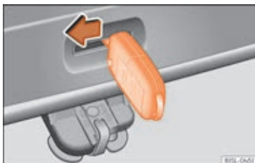
Fig. 8 Fra bagagerummet: nødoplåsning af bagklap
