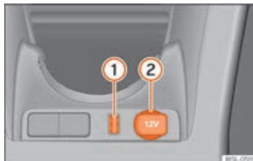
Fig. 134 Midterkonsol foran: 12-volts-stikdåse i opbevaringsrummet og USB-tilslutning
