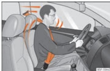
Fig. 70 Hvis sikkerhedsselen er spændt korrekt, bliver føreren ikke kastet frem ved en pludselig opbremsning.
