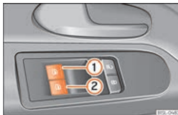
Fig. 11 I førerdøren: kontakter til elruder foran
