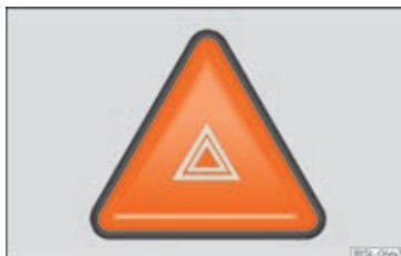
Fig. 111 Instrumentpanel: knap til at tænde og slukke havariblinket med
