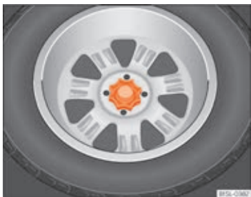
Fig. 193 I bagagerummet: håndhjul til fastgørelse af reservehjul
