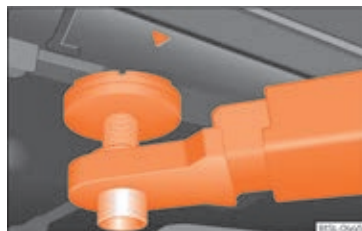
Fig. 178 Løftepunkter bagi til løft af bilen med lift eller donkraft
