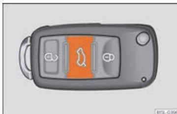
Fig. 107 På bilnøglen: knap til oplåsning og åbning af bagklappen
