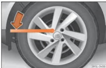
Fig. 54 Hjulskift: løsning af hjulbolte
