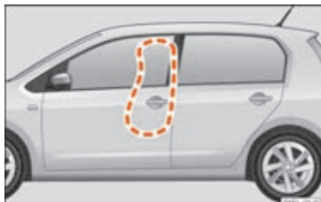
Fig. 23 På venstre side af bilen: udløsningsområde for sideairbaggen
