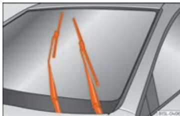
Fig. 62 Viskere i serviceposition
