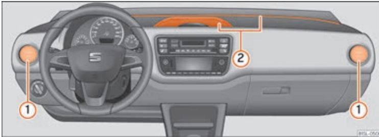
Fig. 144 I instrumentpanelet: luftdyser
