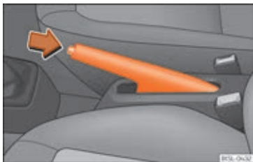
Fig. 164 Mellem forsæderne: håndbremse
