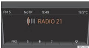
Fig. 151 Skift af station via pileknapper kun muligt til gemte stationer
