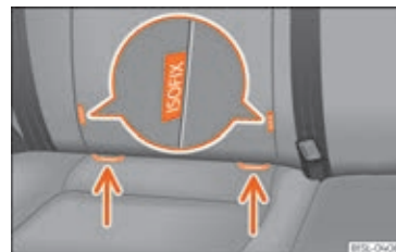
Fig. 27 På sædet: markeringsvarianter ved de nederste holdere til fastgørelse af børnesæder
