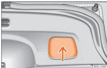
Fig. 108 Åben bagklap: greb til at lukke bagklappen med
