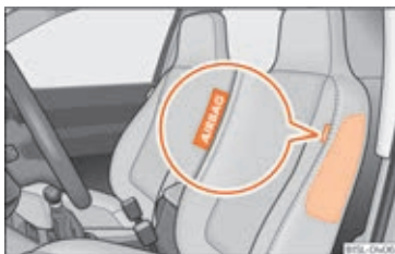
Fig. 22 Forsædet set fra siden: placering af sideairbag
