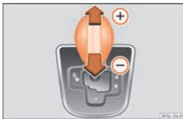
Fig. 167 Gearvælger i tiptronic-position
