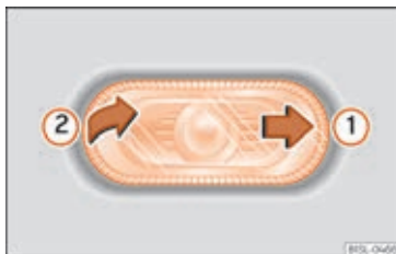
Fig. 93 Afmontering af blinklygte i siden
