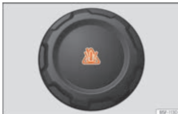
Fig. 43 I motorrummet: dæksel på motorkølevæskeekspansionsbeholder
