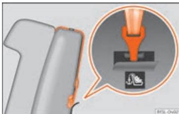
Fig. 28 Eksempel på den øverste fastgørelsesrem, der er hængt på
