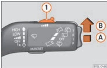
Fig. 115 Betjeningsarm til viskerne: indstilling af regnsensor ①
