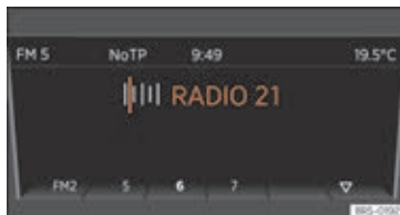
Fig. 152 Station i frekvensområdet FM gemt på stationsknap 6
