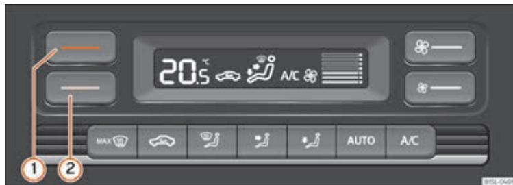
Fig. 145 I den øverste del af midterkonsollen: betjenings-elementer til Climatronic
