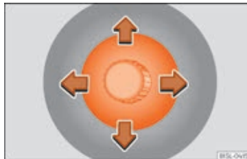
Fig. 118 I fordørene: indstillingskontakt til mekanisk sidespejl
