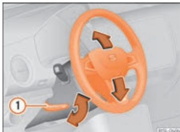
Fig. 18 Mekanisk indstilling af ratposition
