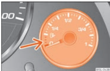
Fig. 180 I kombiinstrumentet: tankmåler til benzin
