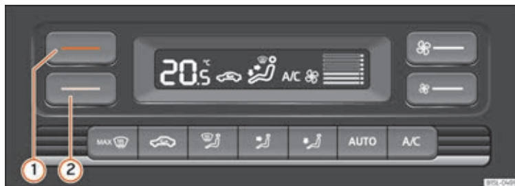
Fig. 38 I den øverste del af midterkonsollen: betjenings-elementer til Climatronic
