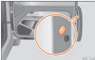
Fig. 5 For enden af passagerdøren: nødlås – gemt bag en gummitætningsliste
