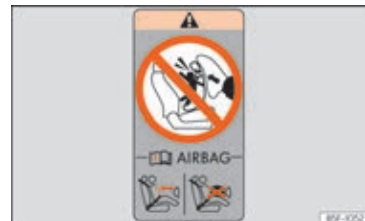
Fig. 25 På passagerdørrammen bagest: mærkat med angivelser vedr. airbaggen
