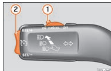
Fig. 35 Knap, kontakt og betjenings-elementer til fartpilot
