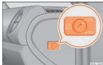
Fig. 21 I passagersiden: nøglekontakt til frakobling af forsædepassagerens frontairbag
