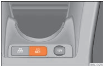
Fig. 192 Midterkonsollen: knap til dækkontrolvisning
