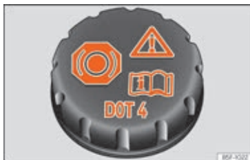
Fig. 44 I motorrummet: dæksel på bremsevæskebeholder
