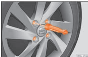
Fig. 58 Hjulskift: Sådan skrues hjulboltene ud med skruetrækkerens greb.
