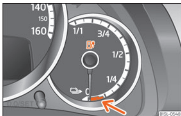
Fig. 142 I kombiinstrumentet: ladetilstandsvisning for højvoltsbatteri med reserveområde markeret med rødt (pil)
