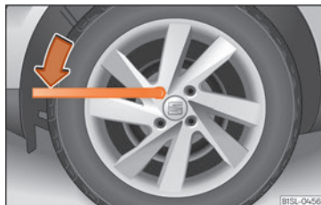
Fig. 33 Hjulskift: løsning af hjulbolte
