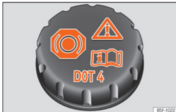
Fig. 156 I motorrummet: dæksel på bremsevæskebeholder
