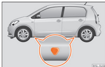
Fig. 35 Løftepunkter til donkraften
