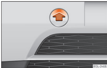
Fig. 42 Højre side af den forreste stødfanger: aftrækning af afdækning
