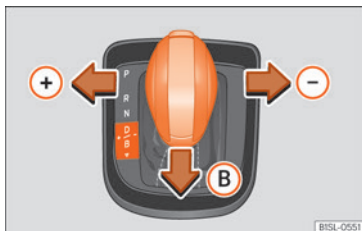
Fig. 128 På gearvælgeren: aktivering af rekuperation
