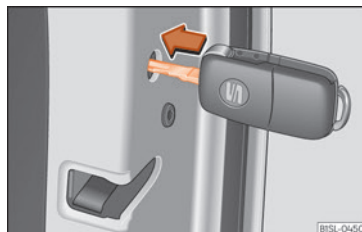
Fig. 71 Nødlåsning af bilen med bilnøglen
