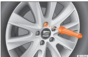
Fig. 78 Hjul: Sådan skrues løsede hjulbolte ud med skruetrækkerens greb.
