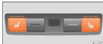
Fig. 189 I midterkonsollen bagi: betjenings-elementer til sædevarme i bagsædepladserne
