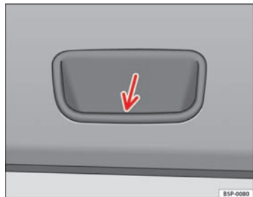
Fig. 52 Udsnit af bagklappens indvendige beklædning: greb til at lukke bagklappen med
