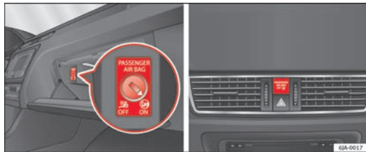
Fig. 24 Kontakt til forsædepassagerens frontairbag/kontrollampe til frakobling af forsædepassagerens frontairbag
