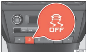
Fig. 104 ESP-system: kontakt til ASR
