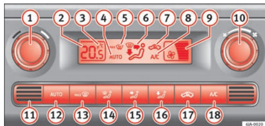
Fig. 100 Betjeningselementer til Climatronic
