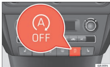
Fig. 111 Kombiinstrument: knap til START-STOP-system
