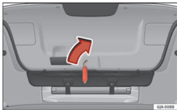
Fig. 53 Nødoplåsning af bagklap
