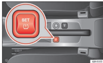
Fig. 128 Knap til indstilling af dæktryk kontrolværdien
