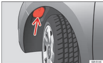
Fig. 149 Udskiftning af pære til nærllys: hjulkasser
